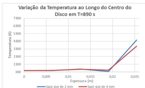
Figura 7.2.3-2 - Temperatura ao longo do centro do disco, disco de 25,4 mm de espessura.
