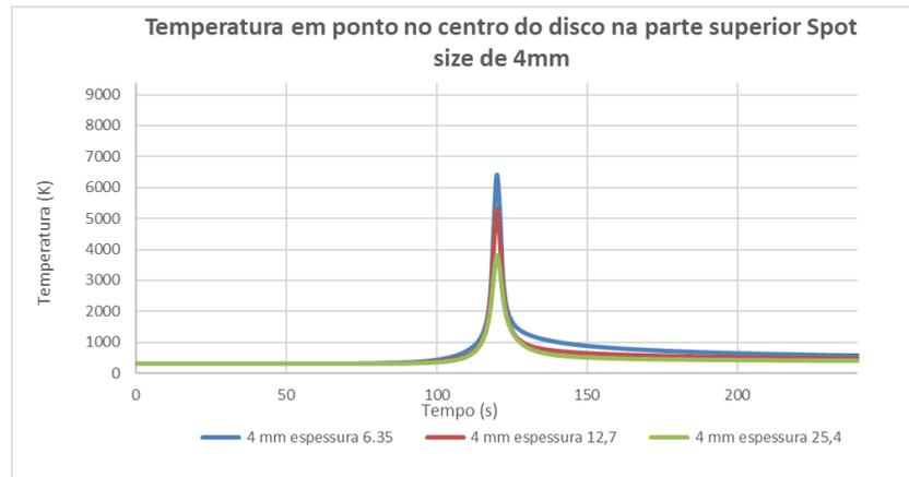
Figura 7.3-2 - Temperatura no Centro do Disco com Diferentes *Spot Sizes* e espessuras, com o Laser em Movimento no Ar.
