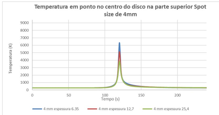
Figura 7.4-1 - Temperatura no Centro do Disco com Diferentes *Spot Sizes* e espessuras, com o Laser em Movimento no Ar.
