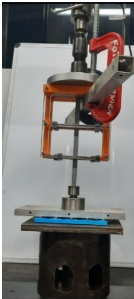
Figura 22 – Coluna reta preparada para o ensaio de flambagem.
