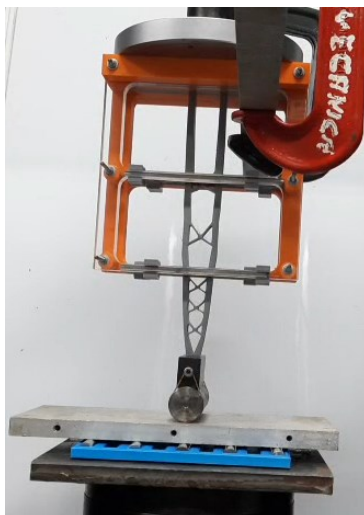
Figura 27 - Configuração sugerida para os ensaios de flambagem em trabalhos futuros.
