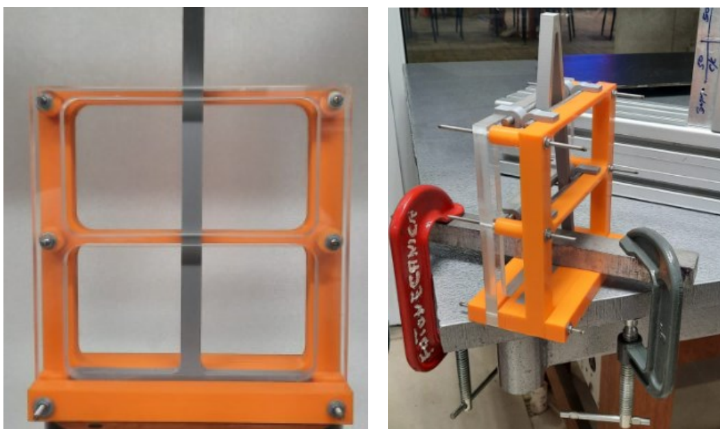
Figura 18 – Ilustrações mostrando como as colunas são acopladas no suporte desenvolvido.
