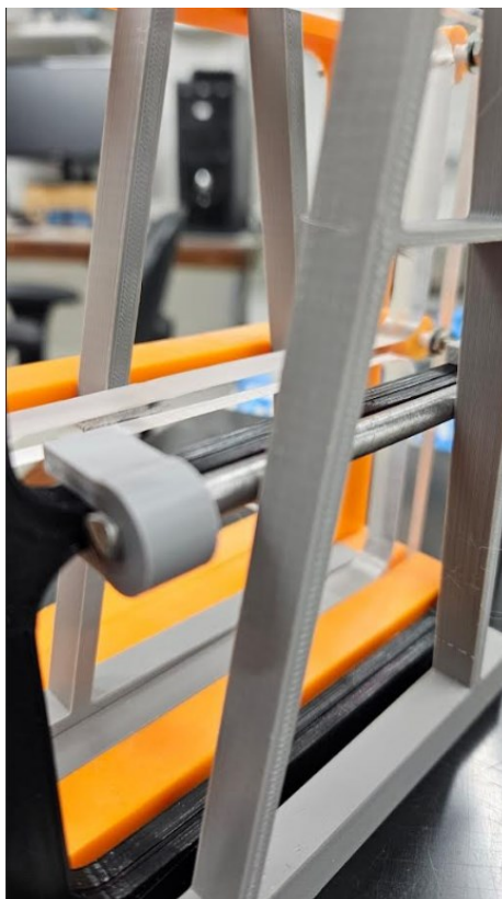
Figura 21 – Encaixe de um eixo de 6mm entre uma das partes principais do suporte e a coluna em A.
