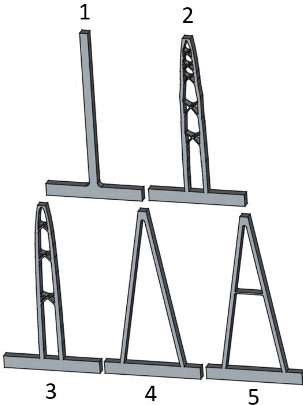
Figura 9 – Modelagem de colunas no software FreeCad, numeradas.
