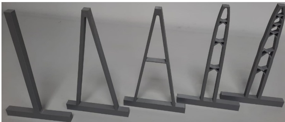
Figura 17 – Da esquerda para a direita: colunas reta, em V, em A, catenária e otimizada impressas.
