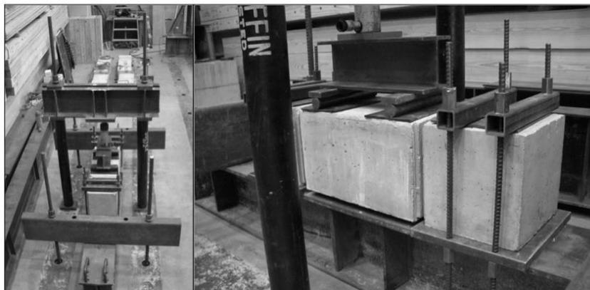
Figura 3.5. Teste AASHTO T253-76 Modificado (PORTER et. al., 2006).
