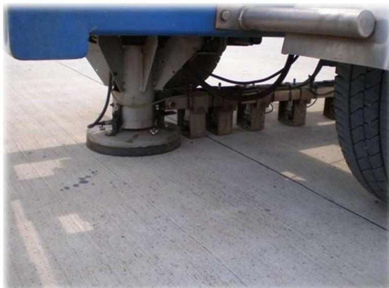
**Figura 3.18. Ensaio *Falling Weight Deflectometer* na medição de deflexão na superfície da placa de concreto (Fonte: Dynatest, CARVALHO, 2011).**
