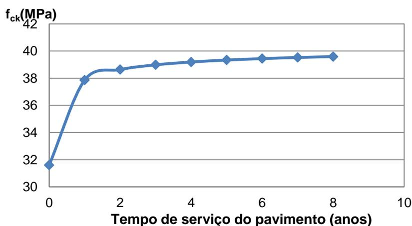
**Figura 4.2. Resistencia a compressão do concreto vs. Tempo de serviço do pavimento.**
