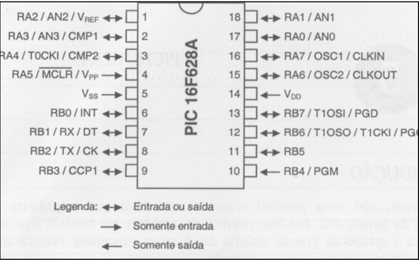
Figura E.1: Pinagem do PIC 16F628A
