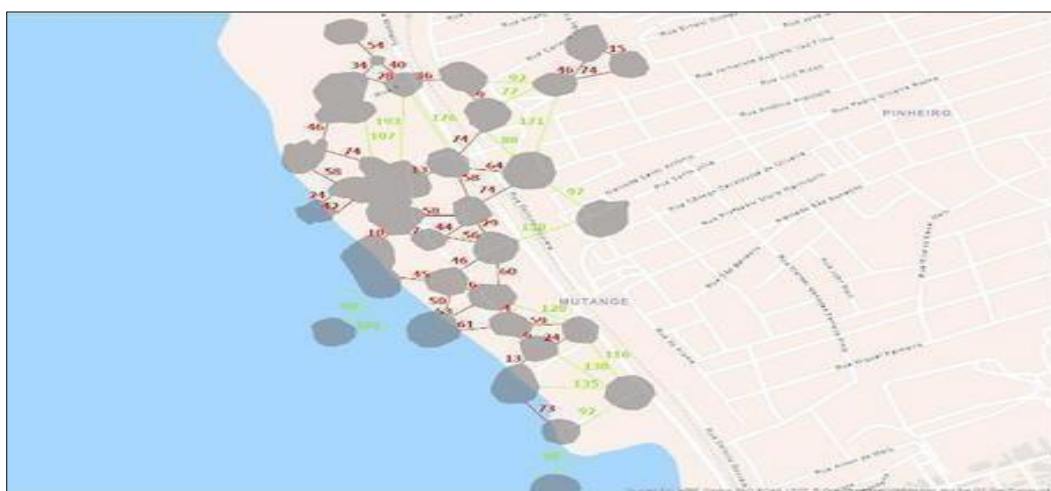
Figura 49 - Distância das minas, em vermelho as que não respeitaram a largura mínima do pilar prevista no plano de lavra Fonte: CPRM (2019)
