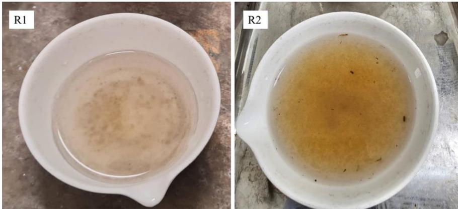
Figura 5.6. Licor misto coletado dos decantadores dos reatores R1 e R2, para determinação da geração de sólidos, na fase IV.
