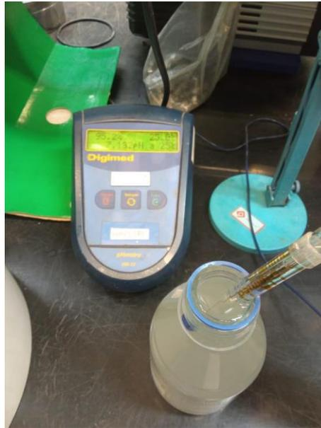
Figura 5.3 Coleta e medição do pH da solução após o período de exposição.
