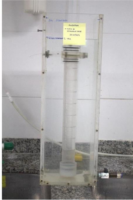
Figura 6.46 Aparato de visualização da imisibilidade entre os fluidos de perfuração e o fluido de tamponamento durante teste de estanqueidade.
