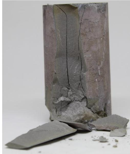
Figura 4.16 Fotografia do modo de falha de um dos corpos de prova ensaiados por compressão simples.
