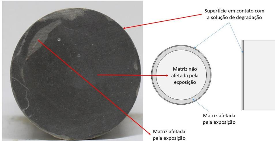
Figura 5.4 Descrição das áreas coletadas das amostras para análise de difração de raio-X.
