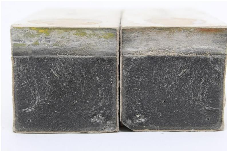
Figura 5.17 Fotografia da seção transversal rompida de uma das amostras após o ensaio de flexão ensaiada após seis meses de exposição das fibras de PVA em salmoura saturada com gás  $\text{CO}_2$ .
