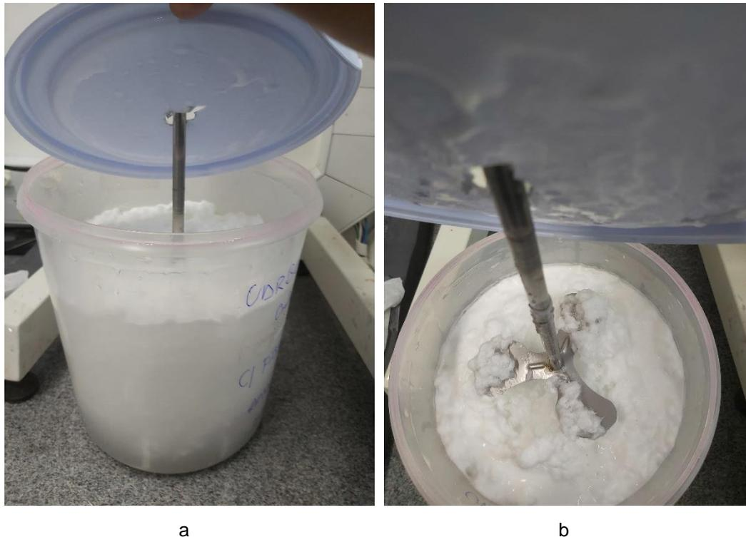
Figura 6.15 Protocolo 2 de homogeneização do carbopol com as fibras de PVA. (a) Repouso das fibras dentro do balde durante o processo de mistura; (b) Detalhe da mistura e dispersão das fibras no carbopol.
