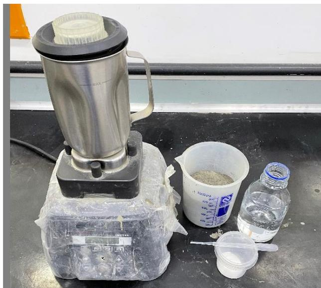
Figura 4.1 Misturador da marca Chandler Ametek, modelo 3260, e materiais utilizados no processo de mistura das pastas de cimento de referência.
