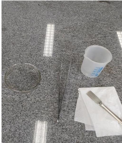
Figura 6.9 Materiais utilizados no processo de separação das frações volumétricas das fibras de PVA.
