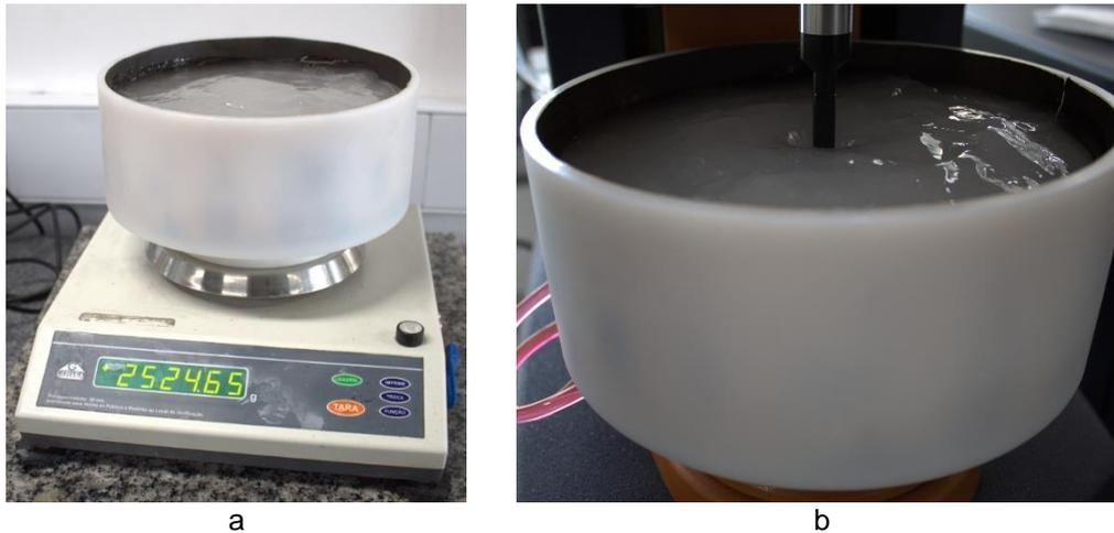
Figura 6.12 Preparação da quantidade de mistura para o ensaio no reômetro. (a) carbopol+fibras de PVA pesados numa balança; (b) Mistura colocada na célula de medição Couette do reômetro para caracterização do fluido.
