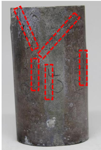
Figura 5.9 Fotografia do modo de falha de um dos corpos de prova ensaiados por compressão simples após 3 meses de exposição na câmara de cura.
