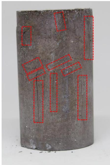
Figura 5.11 Fotografia do modo de falha de um dos corpos de prova ensaiados por compressão triaxial expostos a salmoura saturada com gás  $H_2S$ .
