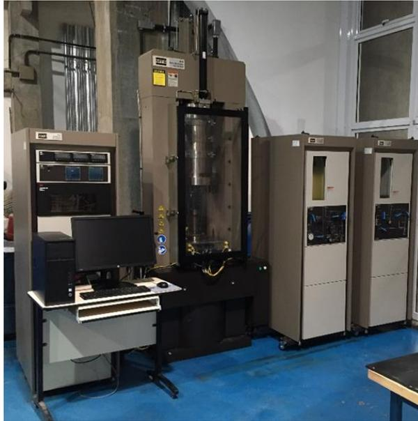
Figura 4.12 Equipamento utilizado para os ensaios de compressão uniaxial e triaxial, MTS modelo 815.
