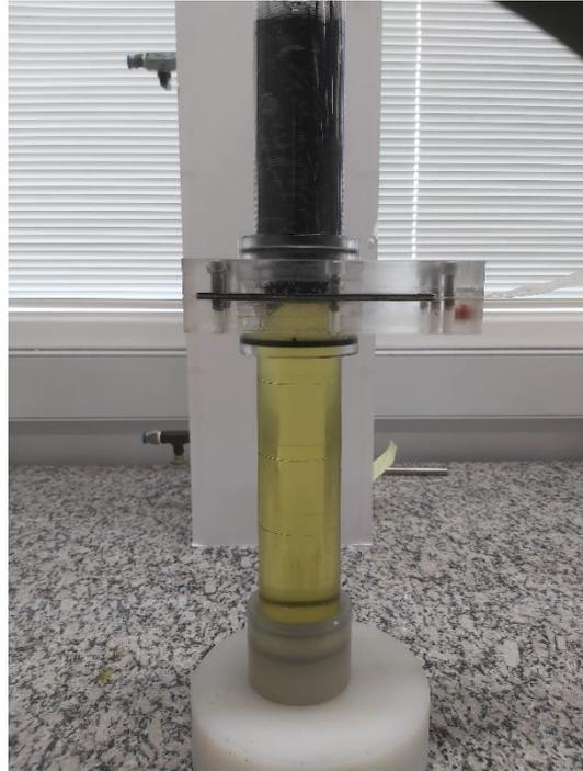
Figura 6.50 Visualização do teste de imisibilidade entre o carbopol e o óleo de cozinha.
