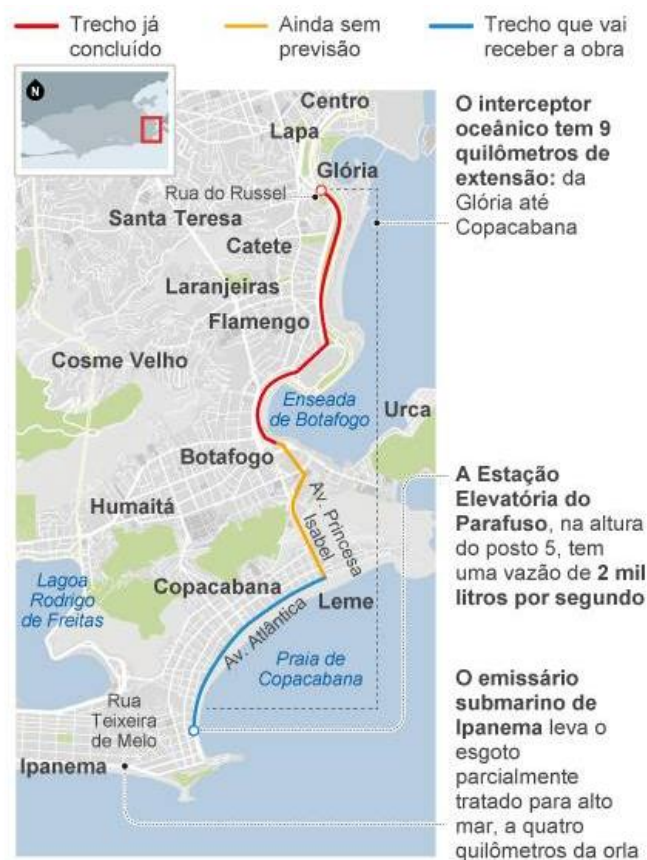
Figura30: Esquema representativo do Interceptor Oceânico até o Emissário Submarino de Ipanema Fonte: Adaptado de Extra (2022)
