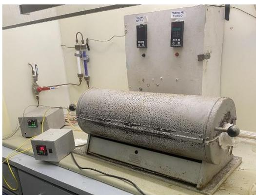
*Figura 4.3.1.1 - Forno com tubo de quartzo usado na pirólise das amostras*
