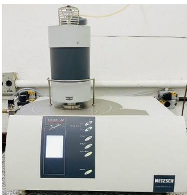
**Figura 4.3.4.1 - Equipamento TGA utilizado na análise das amostras de resíduo de sucata eletroeletrônica pirolisados.**
