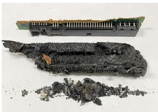
***Figura 5.1.1 - Comparação entre amostra de resíduo de sucata eletroeletrônica antes do processamento térmico (acima), após pirólise (meio) e fragmentado com auxílio de almofariz e pistilo após pirólise (abaixo)***
