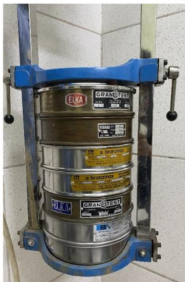
**Figura 4.3.2.1 - Sistema de separação granulométrica com agitador e peneiras**
