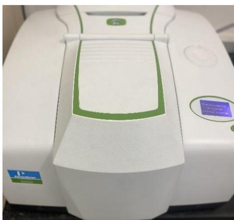
**Figura 4.3.3.1 - Equipamento FTIR utilizado na análise das amostras pirolisadas de resíduo de sucata eletrônica**
