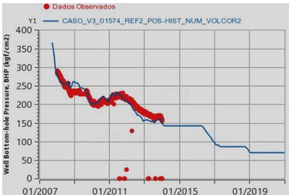
Figura 5-15: Pressão (em kgf/cm<sup>2</sup>) no poço do estudo ao longo do tempo de produção do Campo “P.” (dados observados em vermelho e modelados em azul contínuo).
