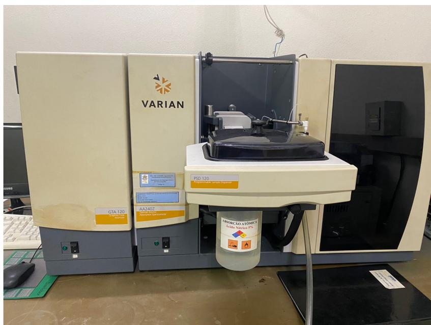
Figura 3.1: Imagem do espectrômetro de absorção atômica com forno de grafite com efeito zeeman obtida no laboratório (arquivo pessoal)
