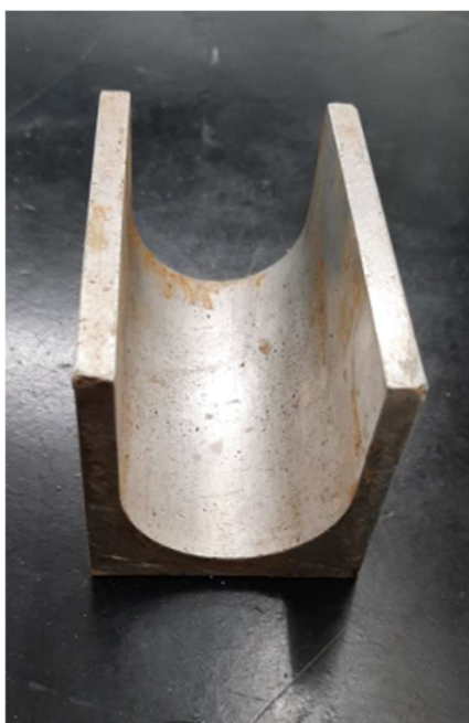
Figura 25- Suporte metálico para preparação do corpo de prova no equipamento triaxial (PUC-Rio).
