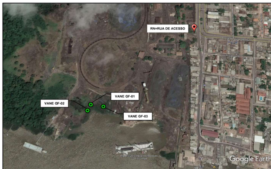
Figura 19- Ilhas de investigação ensaio de palheta (Geoforma, 2019).
