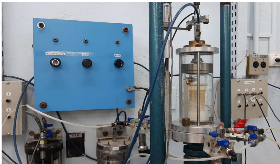
Figura 23- Equipamento triaxial e painel de válvulas reguladoras de pressão (PUC-Rio).
