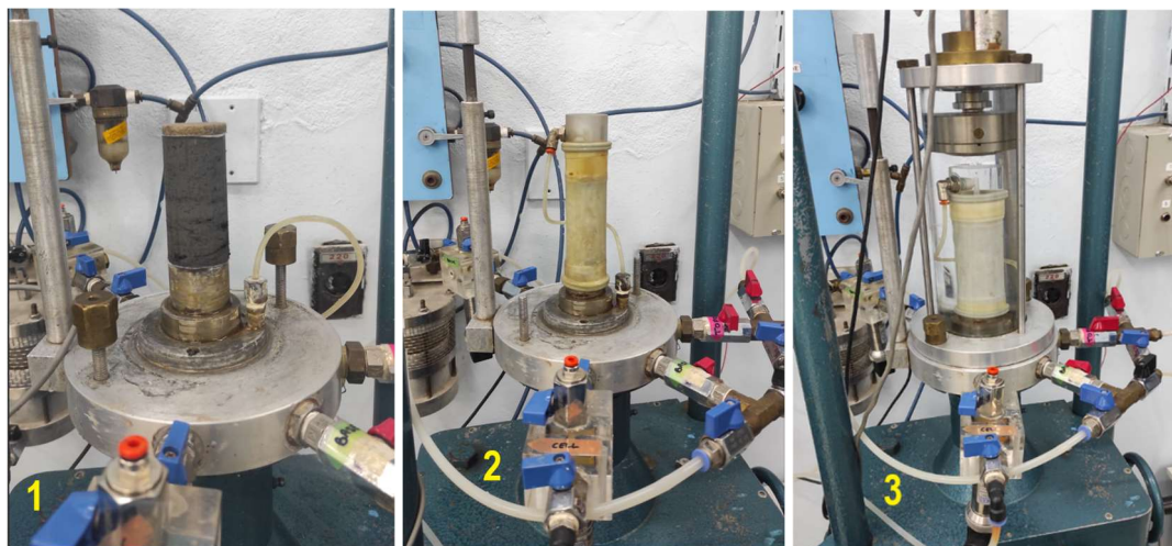
Figura 26-Sequência de montagem do ensaio: 1) Corpo de prova moldado; 2) Corpo de prova envolvido pela membrana látex e acomodação do top cap; 3) Corpo de prova na câmara fechada e cheia d'água
