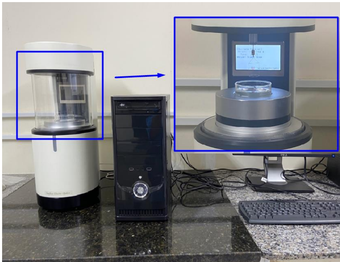
Figura 7. Equipamento para as medidas de tensão superficial (tensiômetro DC 200S), em destaque o anel de Nöuy.
