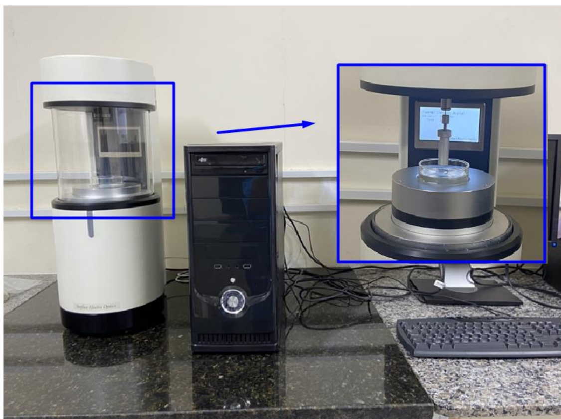
Figura 8. Equipamento para a medição do ângulo de contato (DC 200 Surface Optics).
