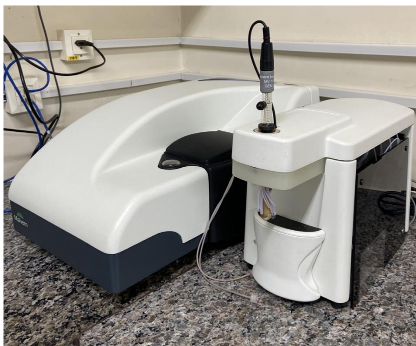
Figura 9. Equipamento de Potencial Zeta (Malvern Zetasizer).
