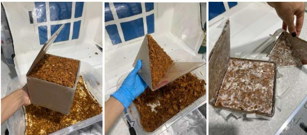
Figura 89 - Moldes preenchidos com serragem colonizada com *Ganoderma tendas (zonatum)*, foto à direita mostrando o crescimento do micélio com 3 dias dentro do molde (Arquivo da autora)
