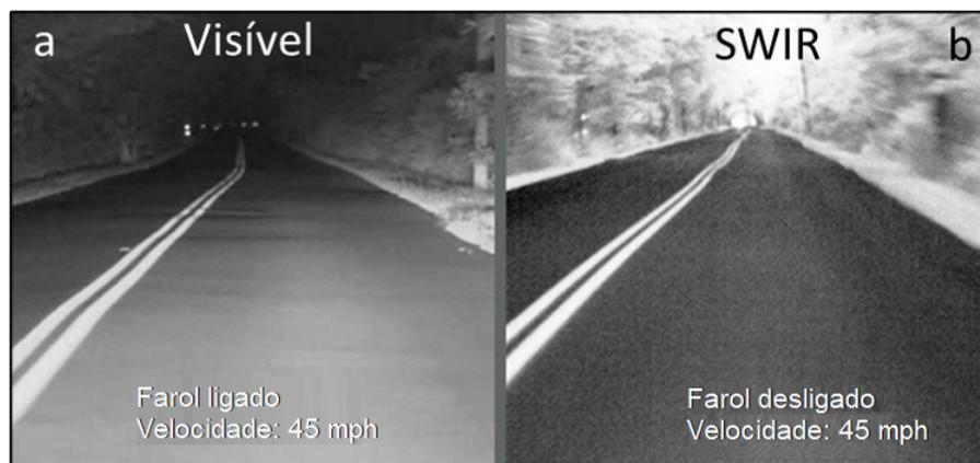
Figura 1.5: Nestas imagens temos uma estrada escura durante o período noturno. Com os faróis acessos (a) é possível observar a estrada, a divisão da pista e as árvores. Porém, usando sensores na faixa do SWIR, mesmo com os faróis apagados (d), é possível observar a via nitidamente.
