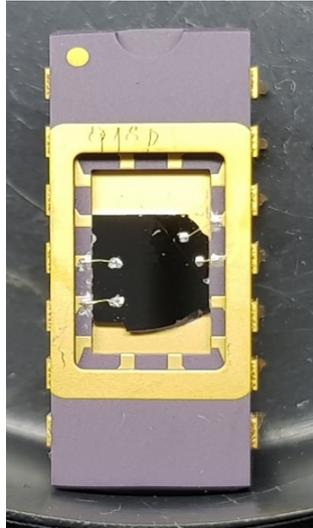
Figura 4.7: Dispositivo preparado para caracterização. No círculo vermelho estão os contatos na camada  $n+$  (InP) e fora do círculo estão os contatos da camada  $p+$  (InGaAs).
