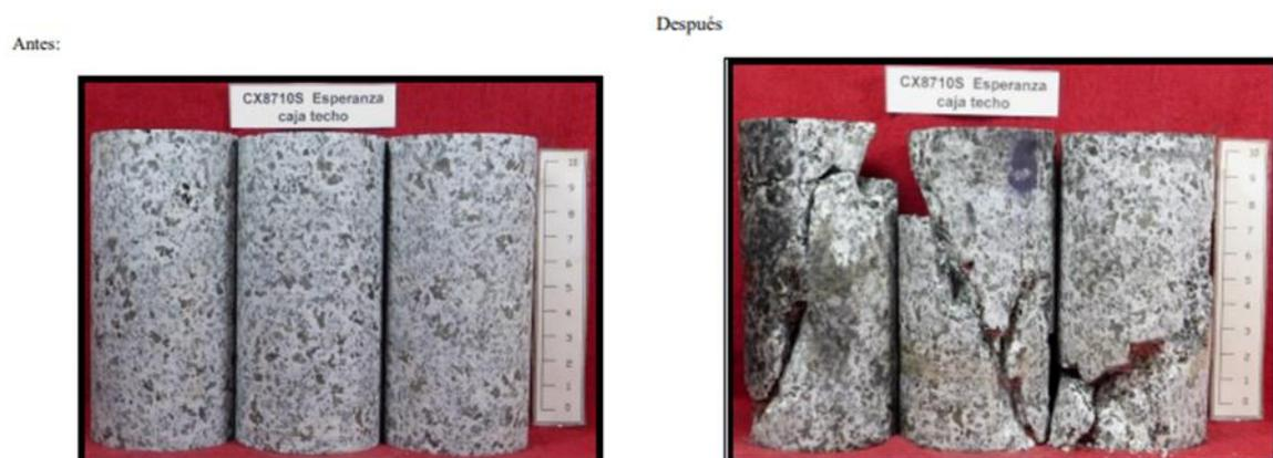
Figura 4.9– Comparação da ruptura do granodiorito em ensaios de compressão uniaxial
