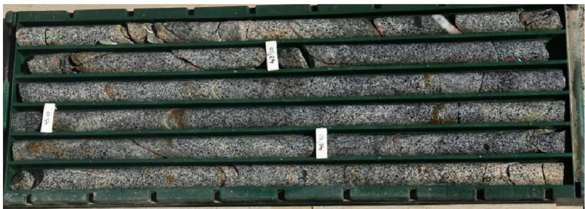
Figura 4.2– Furo geotécnico DDHESP-14A21 (Tramo 42.10 até 47.85 m)
