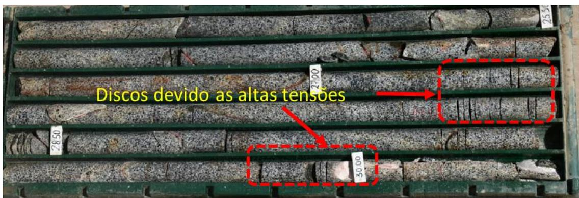
Figura 4.18– Discos de rochas devido as altas tensões nos sondagem geotécnica
