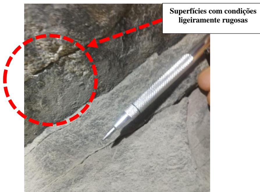
**Figura 4.15–** Características de preenchimento nas descontinuidades e tipo de rugosidade nas paredes (Fonte: Mapeamento geotécnico, 2021)
