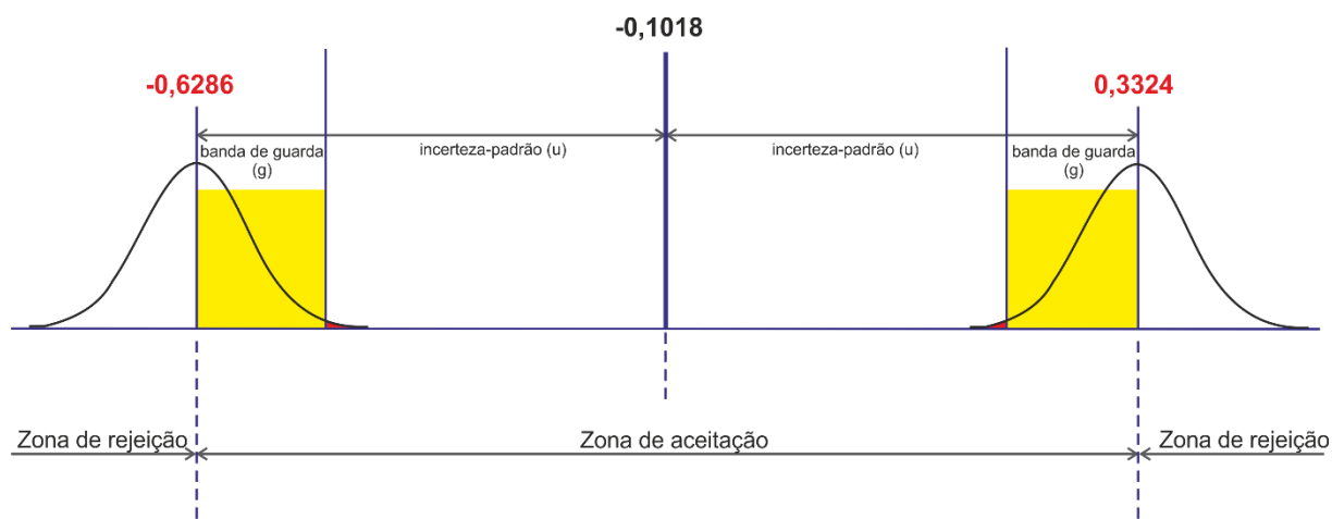
Figura 26 - Representação do intervalo de aceitação para etanol anidro combustível.
