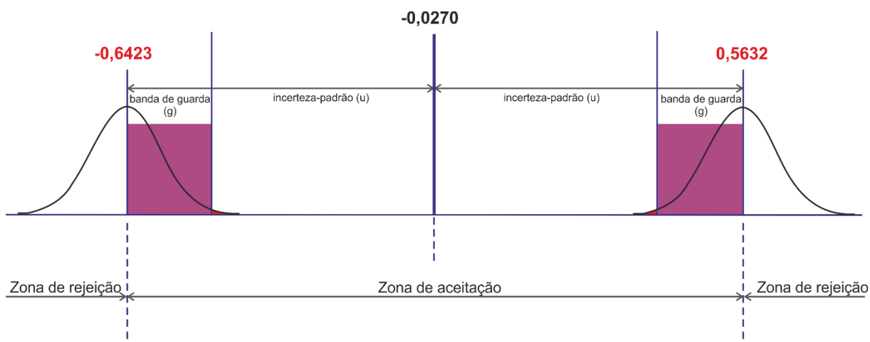
Figura 25 - Representação do intervalo de aceitação para diesel S-500.
