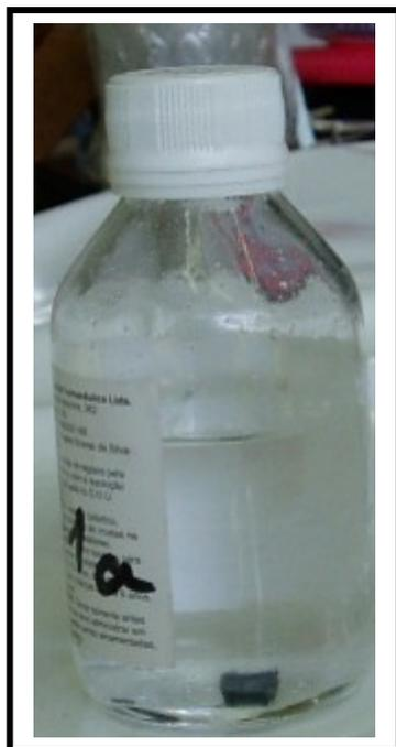
**Figura 16** – Amostra de Óleo Mineral com Chumbo Metálico e Ácido Hexanóico.
