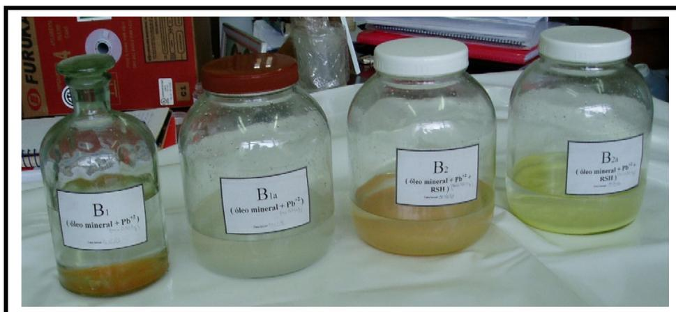
**Figura 21** – Amostras de Óleo Mineral com Óxido de Chumbo II.
