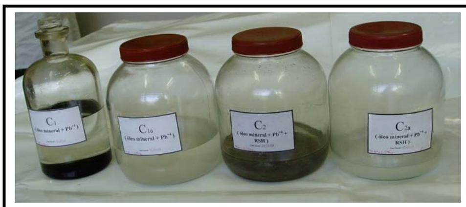
**Figura 25** - Amostras de Óleo Mineral com Óxido de Chumbo IV.
