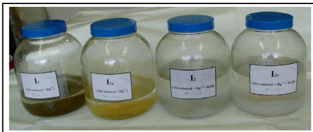
**Figura 41** – Amostras de Óleo Mineral com Óxido de Mercúrio II.
