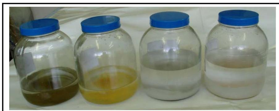
**Figura 42** - Precipitados Formados nas Amostras de Óleo Mineral com Óxido de Mercúrio II.
