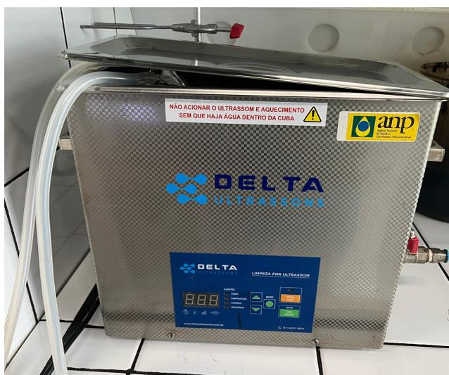
Figura 3.6: Lavadora ultrassônica compacta
