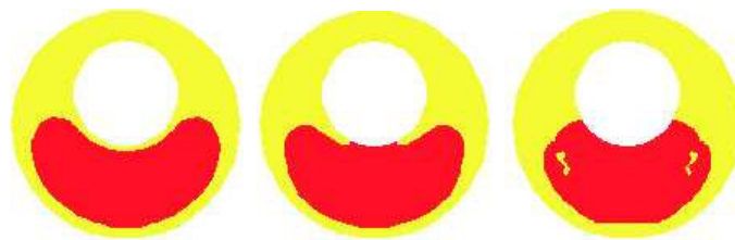
Figura 6.28: Cortes na seção de saída – \chi = 0,5 - 1 BPM - Modelo de Herschel-Bulkley - t^* = 0,6 ; 1,1 ; 2
