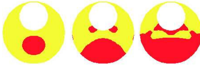
Figura 6.20: Cortes na seção de saída – \chi = 0 - 1 BPM - Modelo de Carreau - t^* = 0,6 ; 1,1 ; 2
