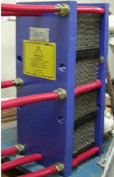
Figura 13 – Trocador de calor a placas da Alfa laval.
