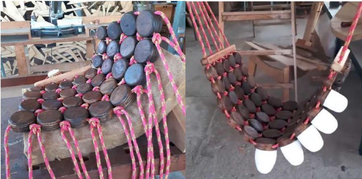
Figura 89: Confeção da trama a partir do compensado (Elaborado pela autora, 2019).
