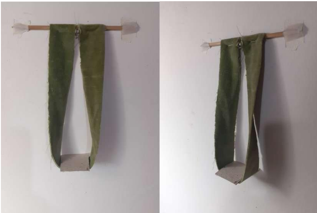
Figura 98: Experiência de assento suspenso pelo revestimento, modelo em escala reduzida. (Elaborado pela autora, 2021).
