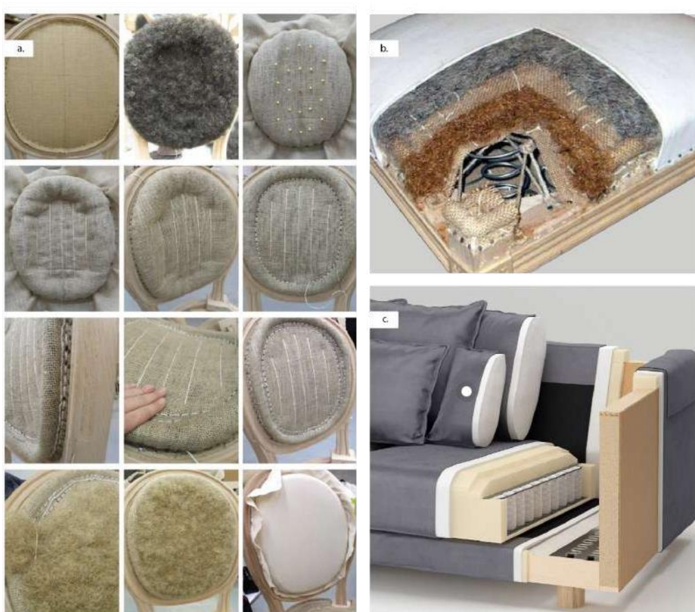
Figura 24: a. Processo de estofaria do encosto de uma cadeira do Atelier Ottomane 48 ; b. Cadeira com estofado aparente 49 ; c. sofá 50 IKEA com estofaria aparente.
