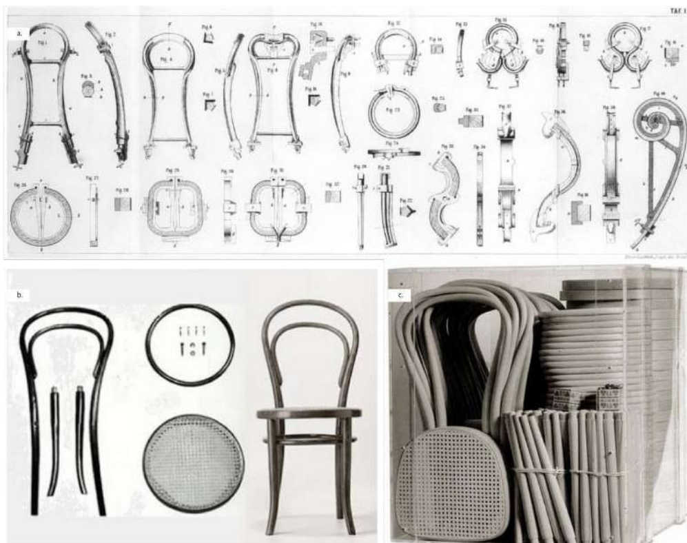
Figura 20: a. esquema de moldes da cadeira Thonet 40 ; b. componentes cadeira Thonet No. 14 41 ; c. componentes estocados 42 .
