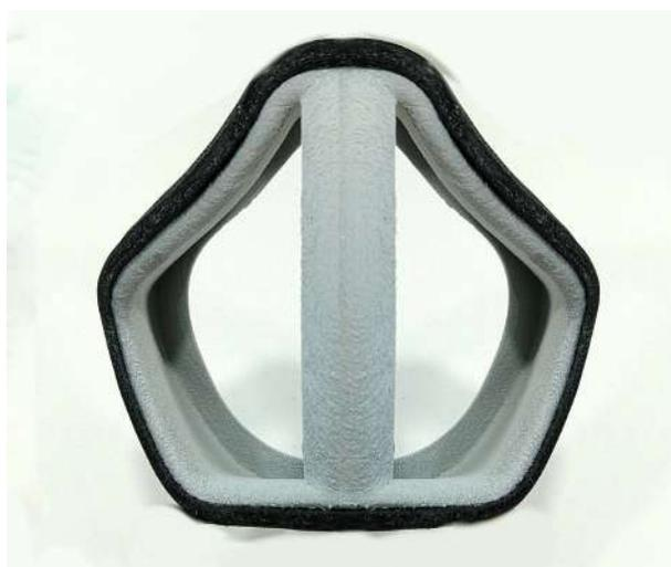
**Figura 4.33** – Modelo A02V11 - concha impressa por SLS em *FlexaBright* (cinza) e aro impresso por FDM em ABS (preto). Fonte: Autor.
