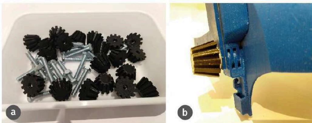
**Figura 3.11** - Peças desenvolvidas e impressas pela equipe para acomodação das porcas (esquerda) e detalhe da dobradiça de abertura da viseira do *face shield* (direita). Fonte: Autor.
