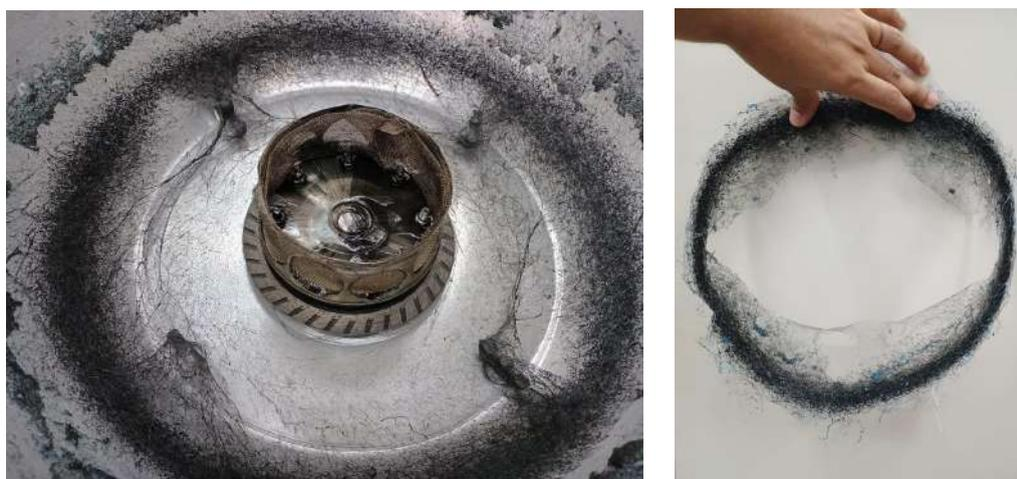
**Figura 5.9** - A temperatura alta derreteu o plástico deixando-o muito fluido, deixando um resíduo sólido na parede do recipiente. Fonte: Autor.
