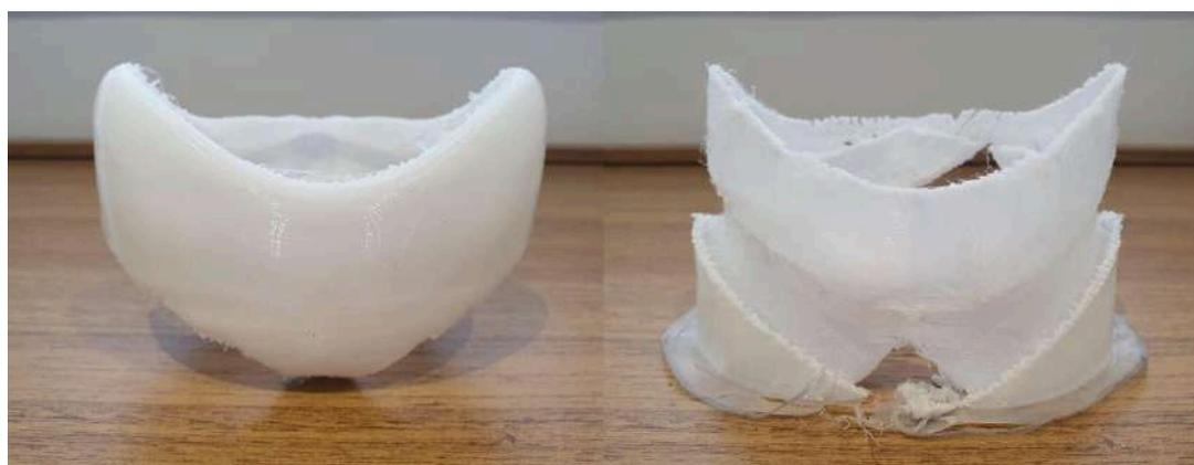
**Figura 4.43** - A máscara A04V04 impressa à esquerda e os suportes necessários extraídos após a impressão à direita. Fonte: Autor.
