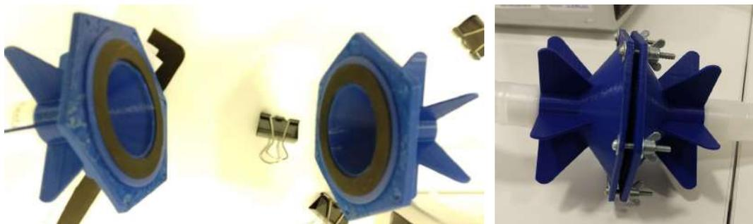
**Figura 4.2** - Peça de suporte modelada e impressa em ABS com anel de borracha em ambos os lados para acomodação do filtro e fechamento hermético do sistema. Fonte: Autor.
