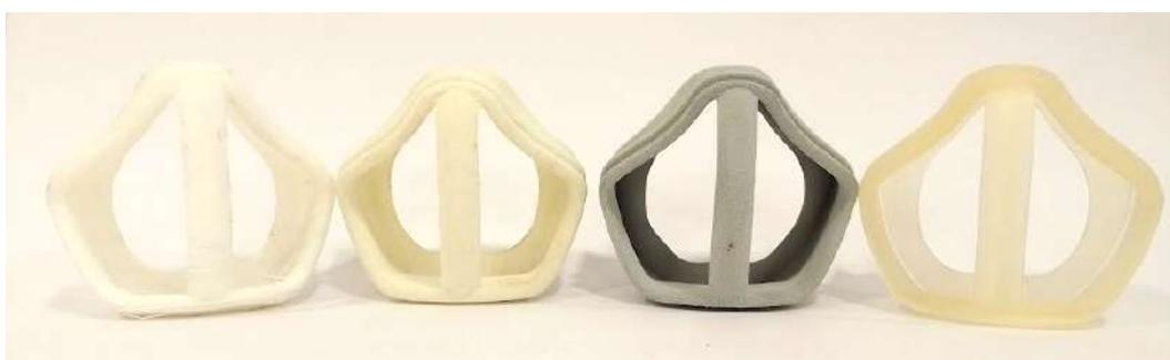
**Figura 7.1** – Conchas finais do modelo A02V11 impressas em diferentes materiais e tecnologias. Da esquerda para a direita: 3dx Shore 88-92 TPE em FDM; Tpu 96 d60 em FDM; *Flexabright* shore 92a em SLS e Resina *high temp* rígida em SLA. Fonte: Autor.
