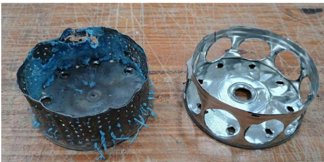
**Figura 5.7** - Primeiros testes feitos para o copo emissor. As duas primeiras tentativas foram feitas utilizando latas de leite em pó, primeiramente fazendo pequenos furos na própria lata com uma broca (esq.) e depois fazendo furos maiores e utilizando uma peneira de fubá como tela para dispersão dos fios (dir.). Fonte: Autor.
