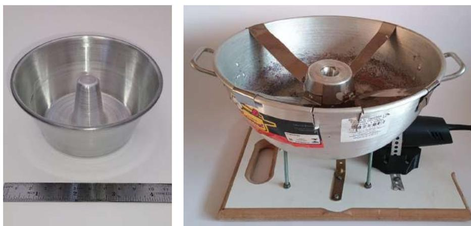
**Figura 5.13** - Mini forma de pudim utilizada para canalizar o ar. Um furo foi feito na parte central para passagem de ar. Fonte: Autor.
