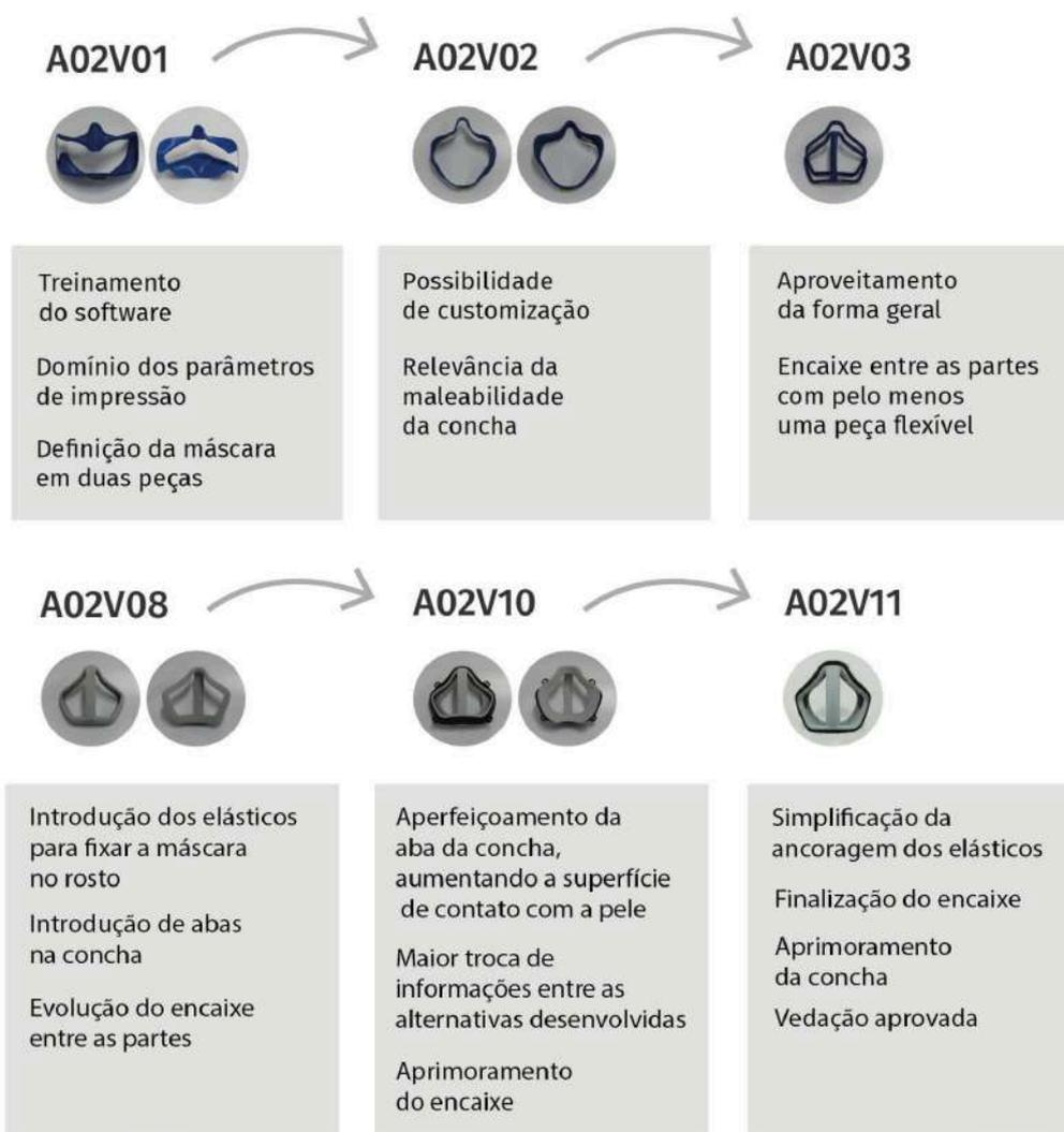
**Figura 4.40** – Esquema com as principais evoluções técnicas e aperfeiçoamentos. Fonte: Autor.
