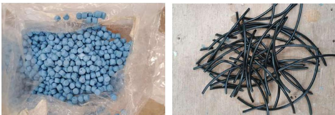
**Figura 5.6** - Pellets reciclados de polipropileno de 4 milímetros e sobras de filamento de PLA. Fonte: Autor.
