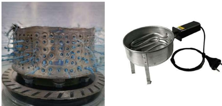
**Figura 5.8** - Detalhe do espaço entre o fundo da lata e o disco de base (esq.) e o fogareiro utilizado para auxiliar no derretimento do plástico (dir.). Fonte: Autor.
