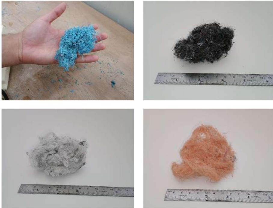
**Figura 5.17** - Velo obtido com os pellets de polipropileno reciclado (azul) e velos de PLA reciclado nas cores preta, branca e laranja. Fonte: Autor.
