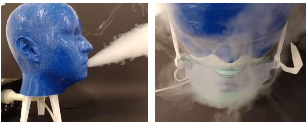
**Figura 4.17** – Cabeça ISO médio adaptada à máquina de fumaça para verificação de vazamentos (esquerda). Os pontos de maior vulnerabilidade foram observados por este processo (direita). Fonte: Autor.
