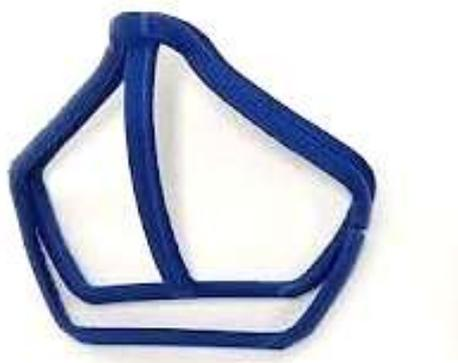
**Figura 4.23** – Modelo A02V03 impresso por FFF em PLA. Fonte: Autor.
