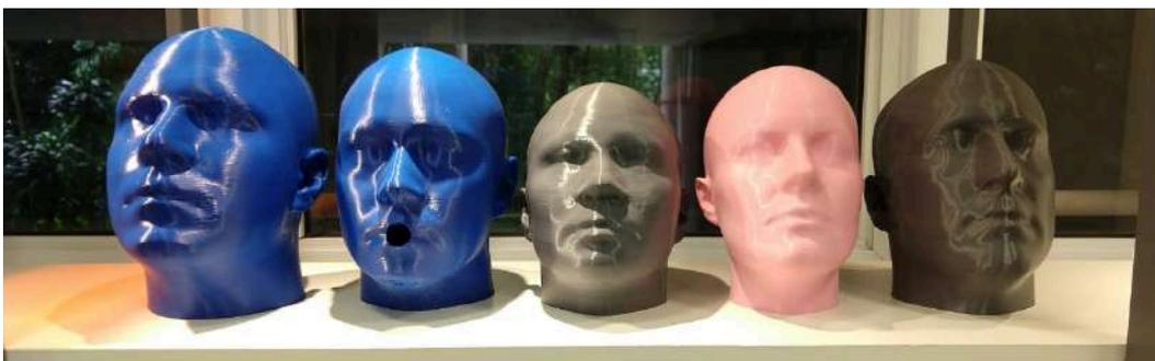
**Figura 2.4** – Modelos impressos. Da esquerda para a direita: ISO grande, ISO médio, ISO curto/largo, ISO pequeno e ISO longo estreito. Fonte: Autor.
