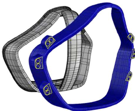
**Figura 4.25** – Modelo A02V08 com sistema de suportes de elásticos em amarelo. Fonte: Autor.
