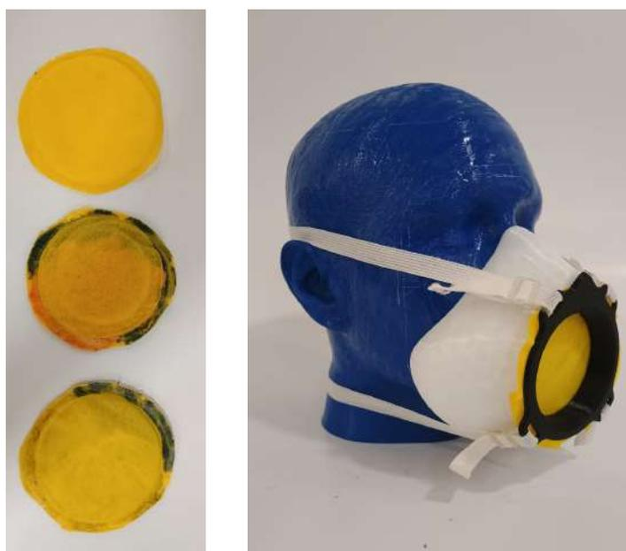
**Figura 5.20** - Três testes foram feitos, utilizando os diferentes velos formados pela máquina de algodão doce (esquerda). À direita, a máscara A01V16 com o filtro *mockup* integrado. Fonte: Autor.
