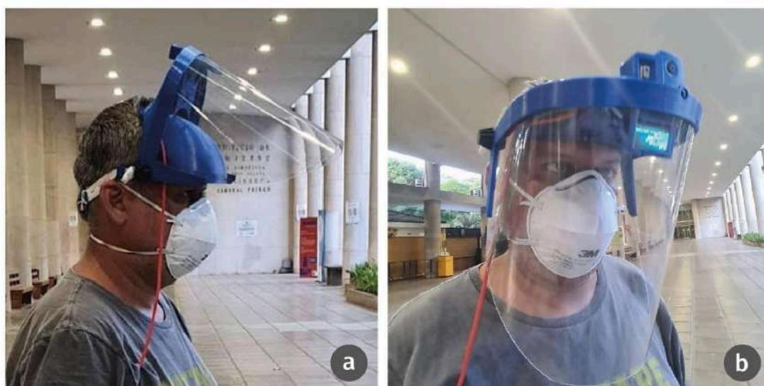
**Figura 3.24** - *Face shield* com a viseira aberta (a) e fechada (b) em teste. Fonte: Autor.
