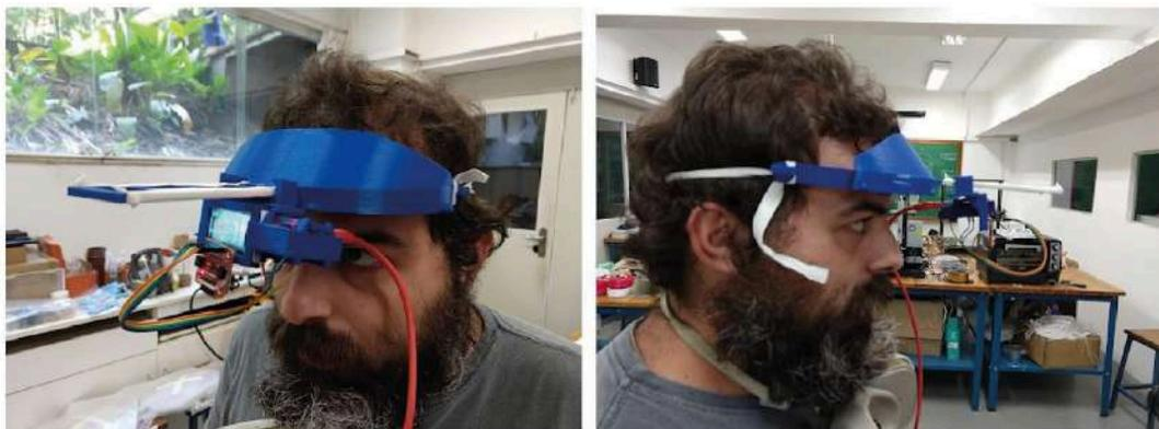
**Figura 3.3** - O primeiro protótipo, sendo utilizado para verificação da distância da tela aos olhos. Fonte: Autor.
