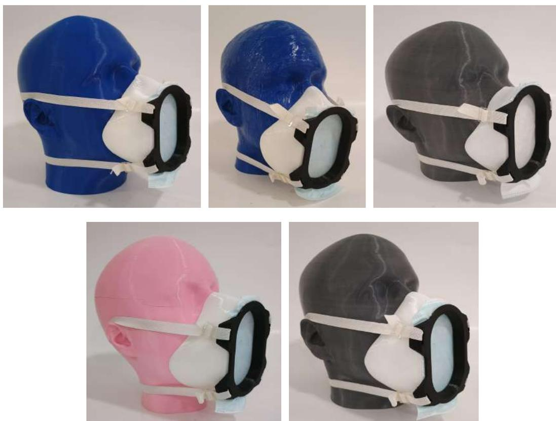
**Figura 4.62** - Máscara A01V19 impressa nos tamanhos ISO grande, médio, curto, pequeno e longo (da esquerda para direita, de cima para baixo), cada um com a concha própria para o modelo. Fonte: Autor.
