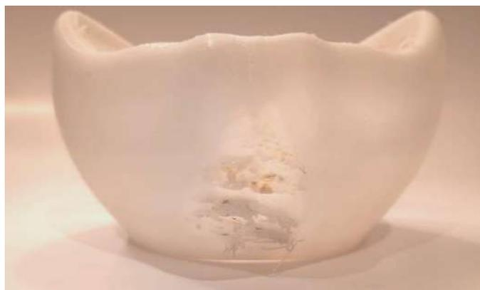
**Figura 4.47** - Máscara A01V14 vista de topo evidenciando a falha de impressão observada na região do nariz. Fonte: Autor.
