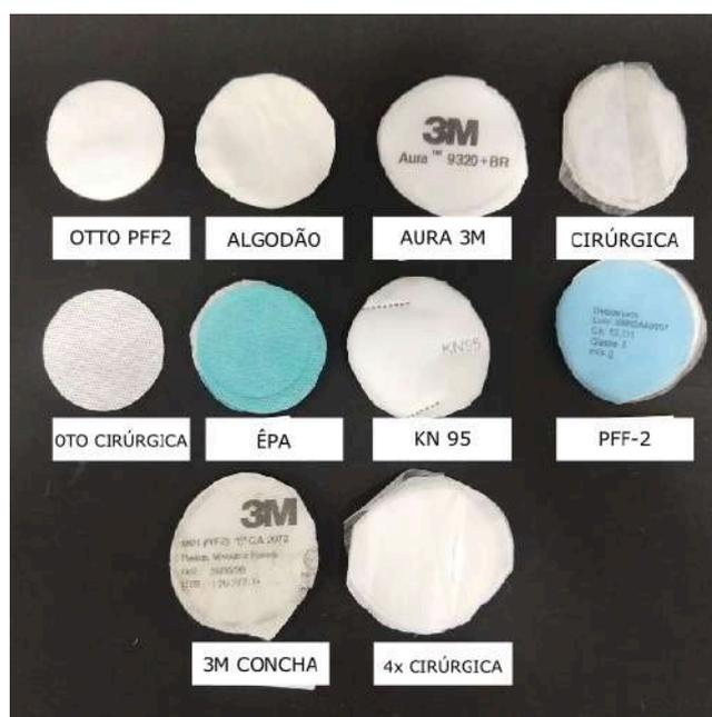
**Figura 4.5** - Os filtros utilizados em formato de círculo com diâmetro 50 mm para testagem. Fonte: Autor
