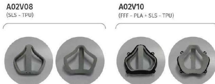
**Figura 4.30** – Modelos impressos V08 e V010. Na impressão das conchas pode ser observada a diferença de tamanho entre as abas da concha. Fonte: Autor.
