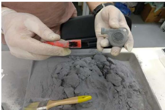
**Figura 2.2** - Processo de limpeza da peça com remoção do pó não sinterizado, que serve também como suporte. Fonte: Autor.
