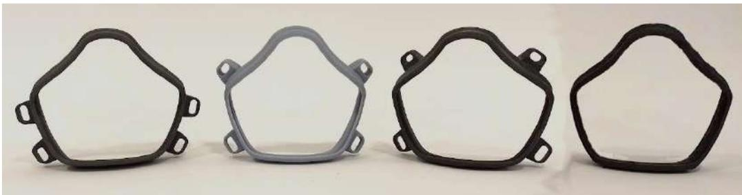
**Figura 4.34** – Alguns estudos do sistema de suportes de elásticos. Fonte: Autor.
