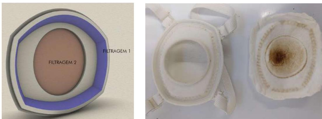
**Figura 6.3** - Previsão de áreas de passagem de ar e marcas da fumaça no filtro experimental. Fonte: Autor.
