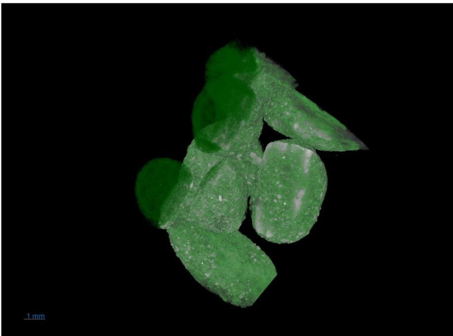
Figura 66: Imagem 3D da MT a sinterizar COP +2,80 mm mostrando a camada aderente em verde
