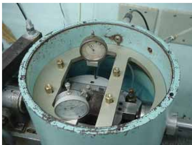
Figura 22: Disco espaçador com os quatro parafusos e os dois extensômetros.
