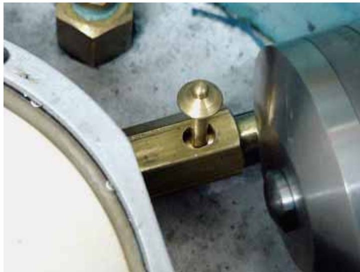
Figura 23: Detalhe do pino de acoplamento entre a caixa e a haste.
