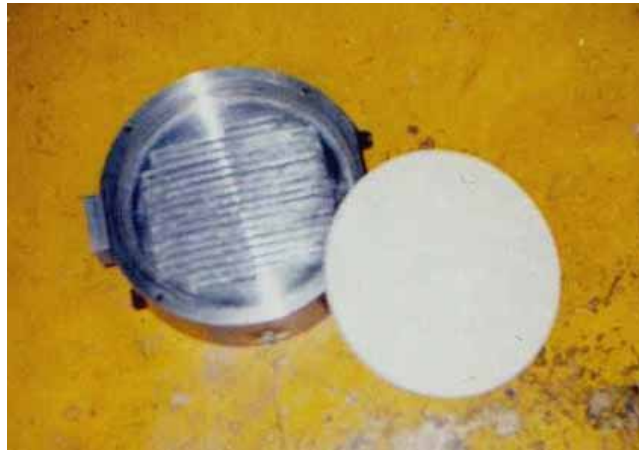
Figura 21: Câmara de água e o DAVE.
