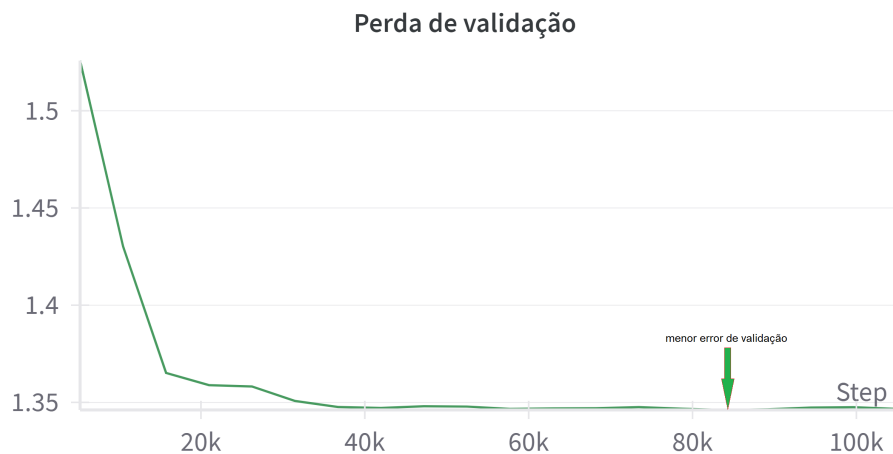
Figura 4.5: Imagem ilustrativa mostrando a curva de perda de validação do Gerador de Layout sintéticos. O menor erro de validação ocorreu na iteração 83.920, ou seja, na época 16.
