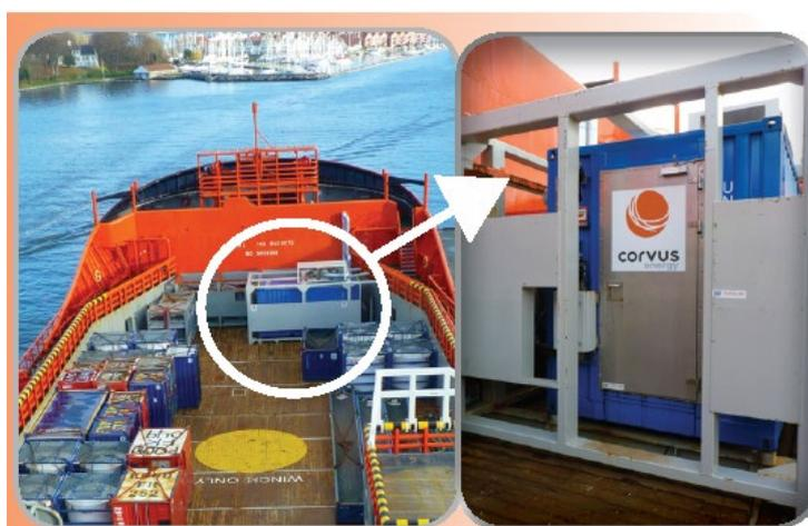
Figura 30: Sistema compacto de armazenamento de energia numa embarcação. *Plug and Play*. Fonte: [8]
