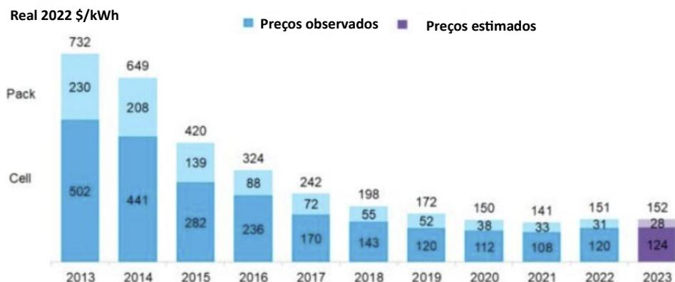
Figura 29: Evolução dos valores em \$/kWh para baterias Li-Ion. Valores reais em azul e previstos em roxo. Fonte: [57].
