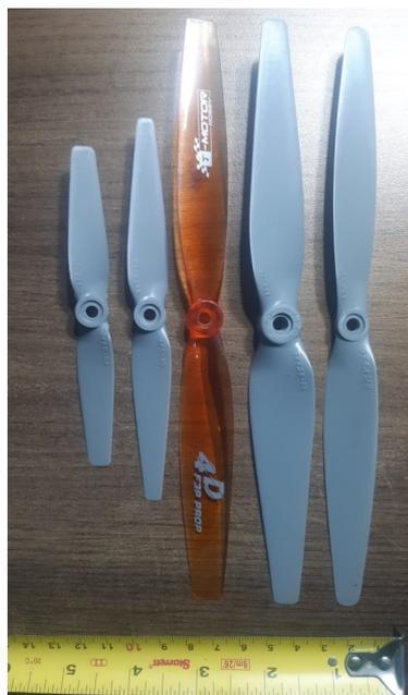
Figura 5.54: Hélices considerados nos testes, da esquerda para a direita: APC© 3D 5 × 4 R-LH/R-RH, APC© 3D 6 × 3 R-LH/R-RH, TMotor© 4D 9 × 4, APC© 3D 9 × 45 R-LH/R-RH e APC© 4D 9 × 44 SFR.
