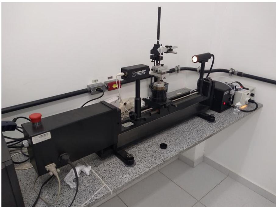
**Figura 3.31.** Goniômetro automático modelo 590 F3 Series da *Ramé-Hart Instruments Co.* com acessório de inclinação automática da mesa.
