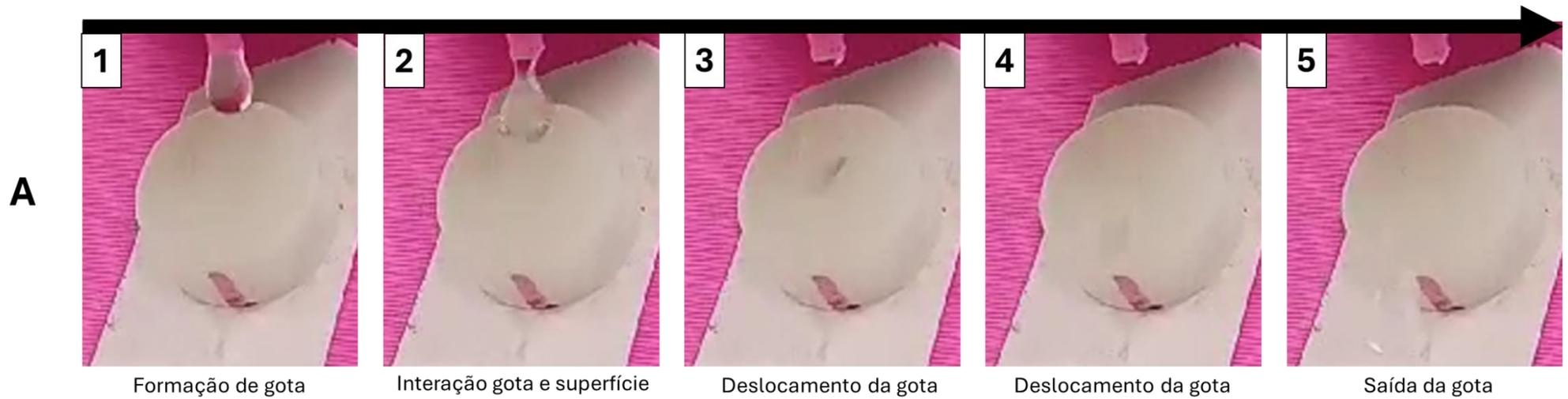
**Figura 3.82.** Sequência de imagens capturadas durante o ensaio de autolimpeza executado na combinação revestida A (PA 6 + NP/L + UVO + Fluor).
