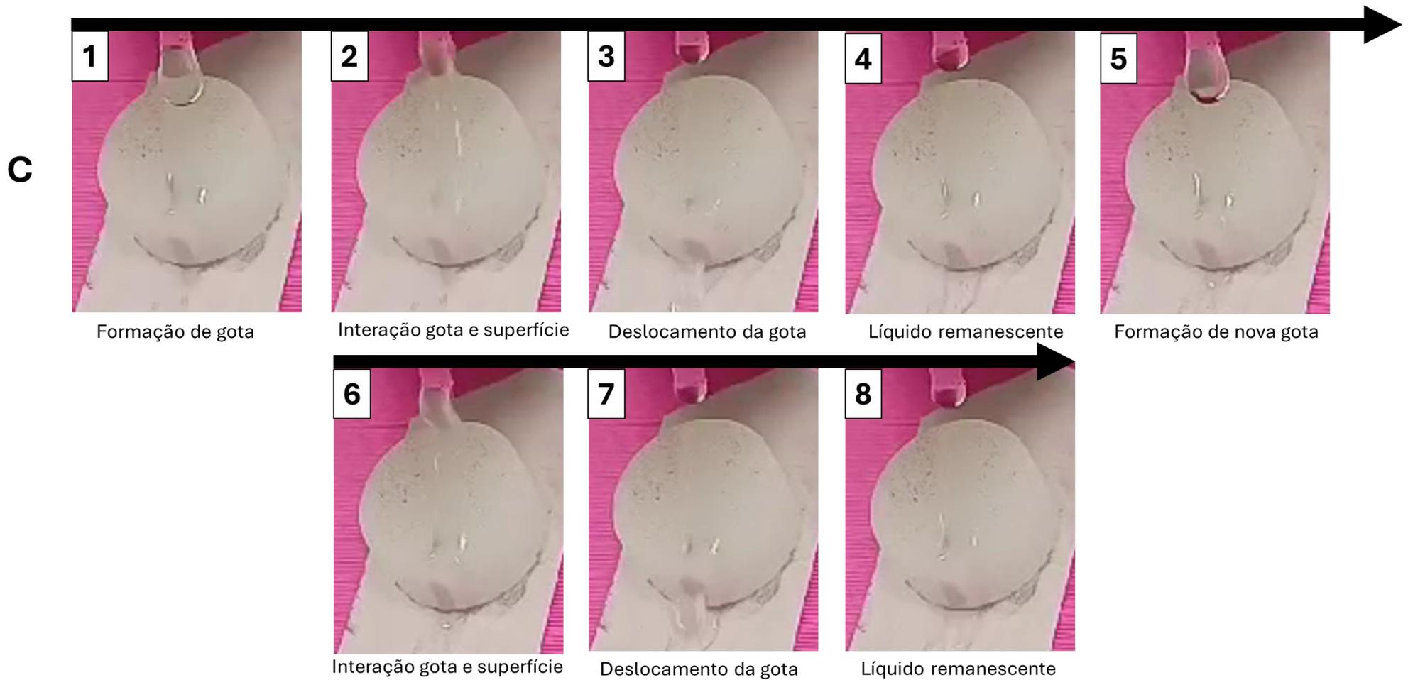
**Figura 3.84.** Sequência de imagens capturadas durante o ensaio de autolimpeza executado na combinação revestida C (PA 6 + NP/L + Fluor).
