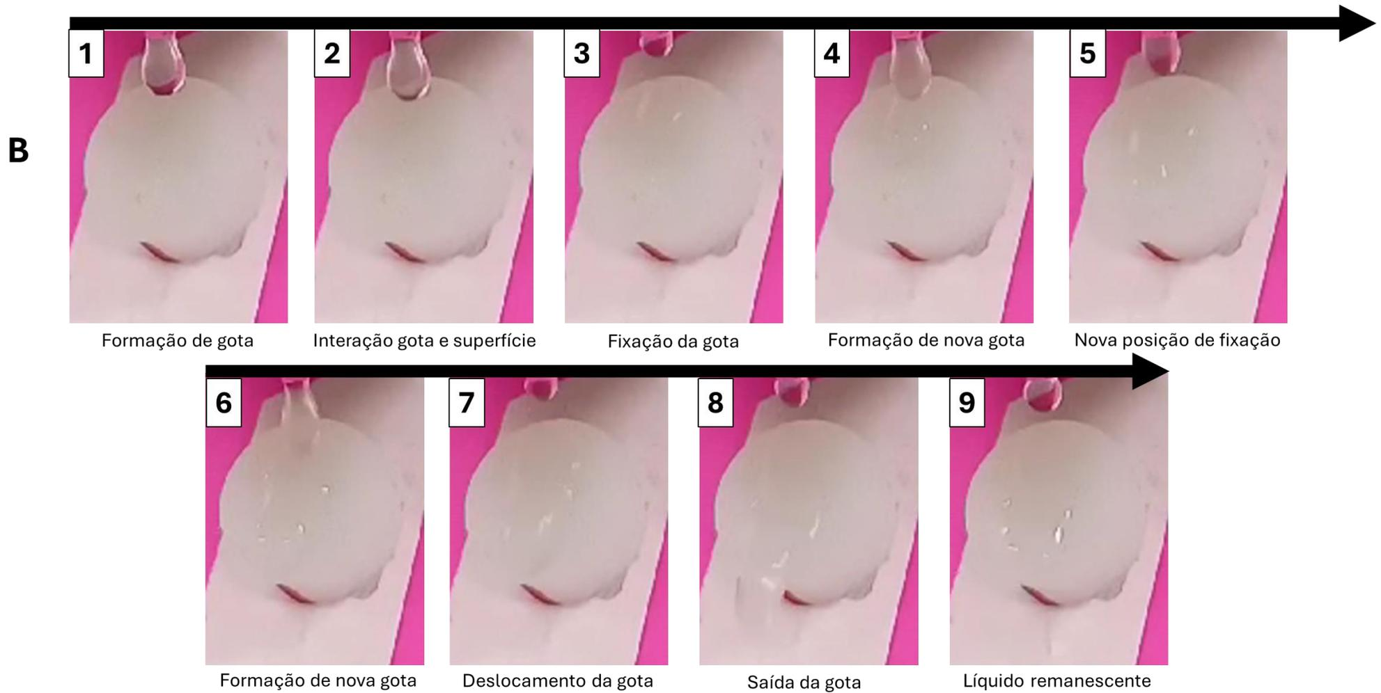
**Figura 3.83.** Sequência de imagens capturadas durante o ensaio de autolimpieza executado na combinação revestida B (PA 6 + NP/L).
