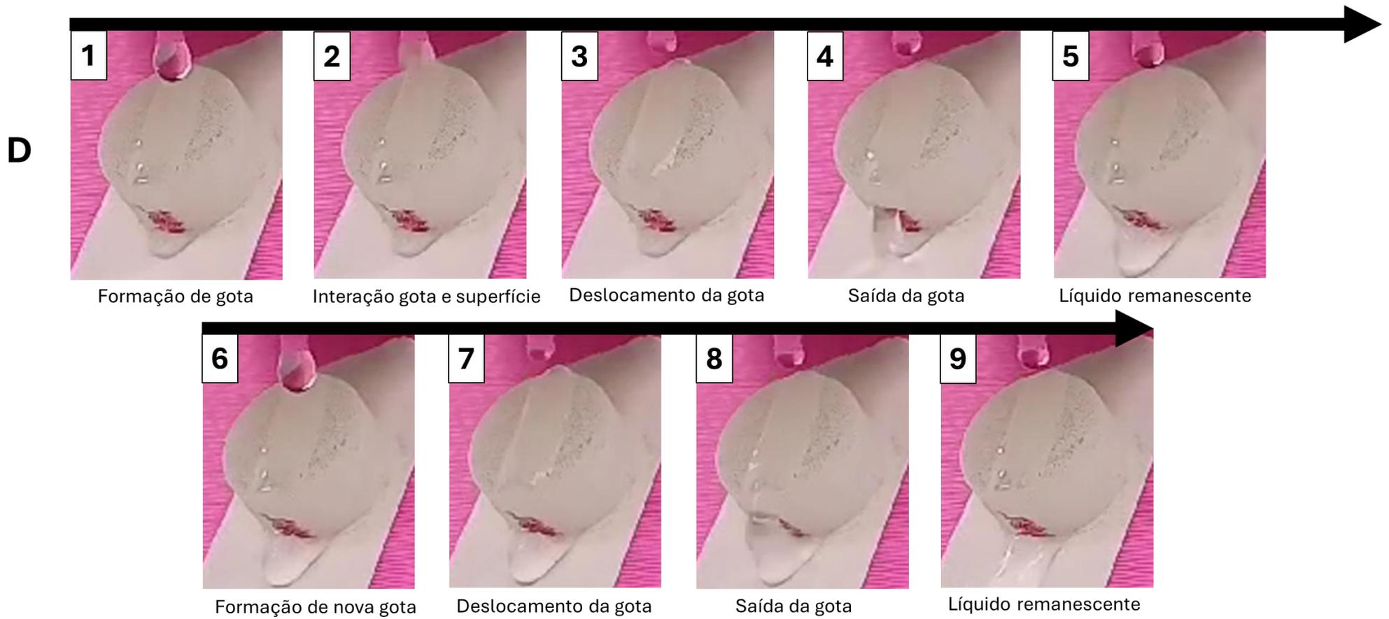
**Figura 3.85.** Sequência de imagens capturadas durante o ensaio de autolimpeza executado na combinação revestida D (PA 6 + Fluor).
