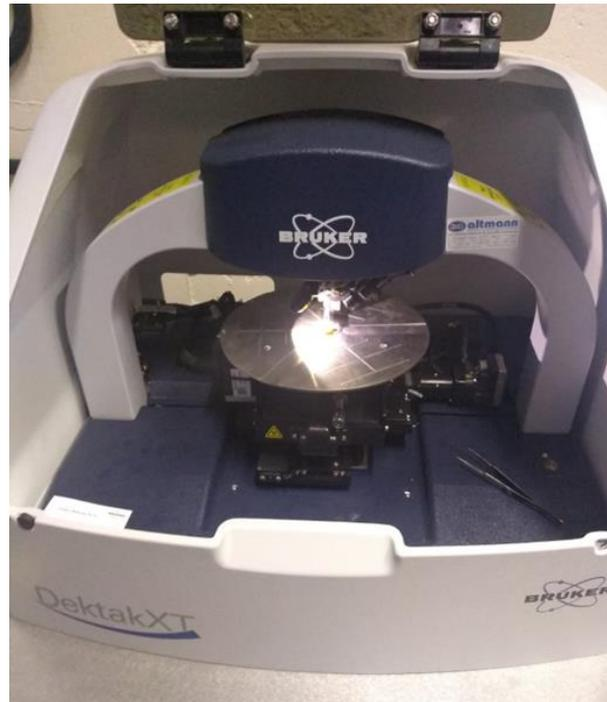
**Figura 3.27.** (a) Perfilômetro de contato DektaXT (Bruker).
