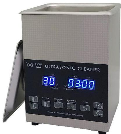
**Figura 3.15.** Banho ultrassônico de 2L da *Allcrom*.
