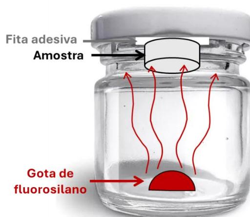
**Figura 3.24.** Imagem esquemática da configuração empregada para deposição química de vapor de fluorossilano sobre as amostras.
