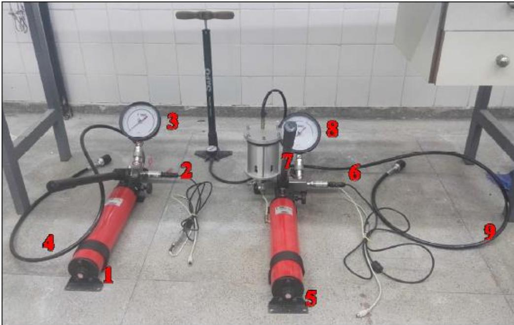
Componentes: 1: Macaco hidráulico de aplicação de carga tangencial; 2: Célula de carga; 3: Manômetro; 4: Mangueira de conexão; 5: Macaco hidráulico de aplicação de carga normal; 6: Célula de carga; 7: Suporte pneumático de pressão; 8: Manômetro; 9: Mangueira de conexão.
