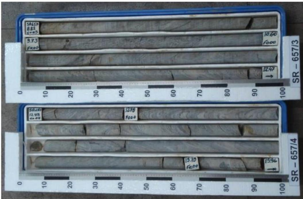
Figura 3.10 - Testemunho recuperado do furo de sondagem SR – 657: Profundidade de 8,82 a 15,96m (Salles, 2013).
