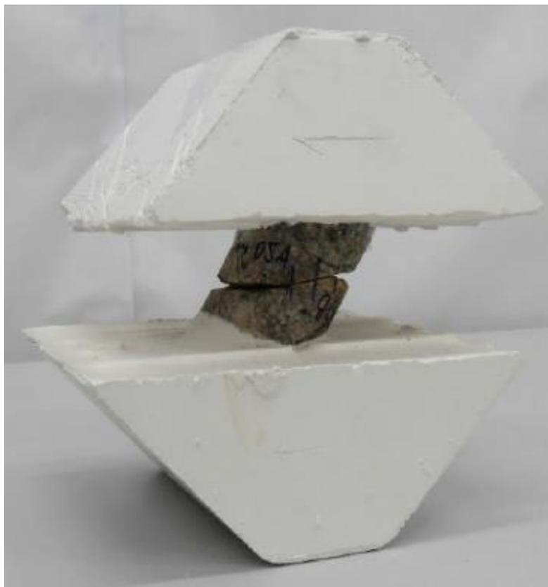
Figura 3.20 – Contato da junta após encapsulamento em moldes de gesso (Steffens, 2018).
