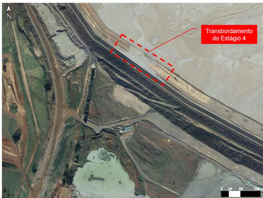
Figura 4.3: Foto aérea de 2010 na região da ruptura. A imagem mostra o Estágio 4 concluído e a plataforma de construção do Estágio 5. Destaque para a região de transbordamento do Estágio 4.
