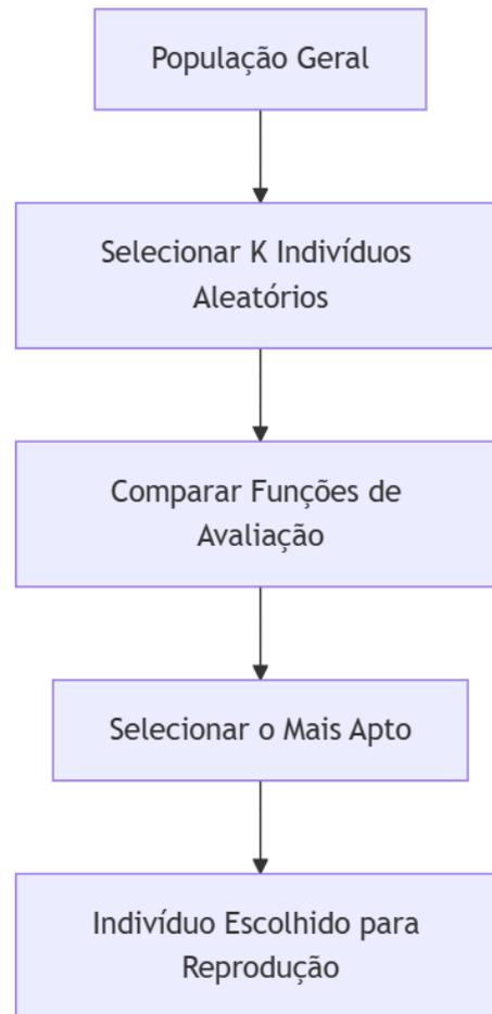
Figure 5: Fluxograma da Lógica da Seleção por Torneio
