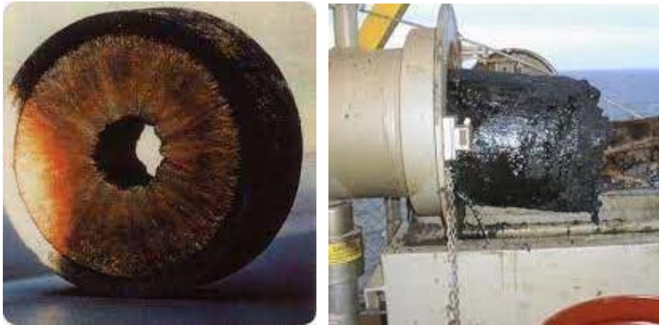
Figura 1.2 - Exemplos de deposição de parafina em dutos de petróleo (NTNU, 2011)
