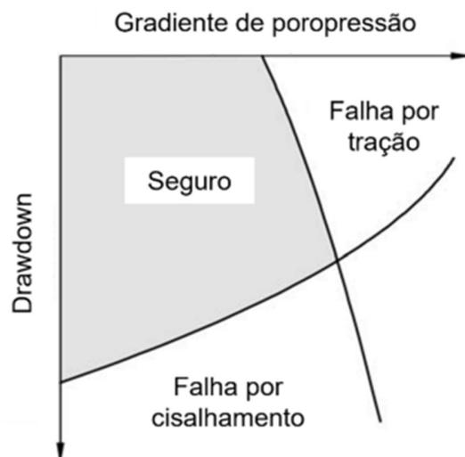
**Figura 2-6: Diagrama com as envoltórias de estabilidade de acordo com os valores de drawdown e gradiente de poropressão (Adaptado de Fjaer et al., 2008).**
