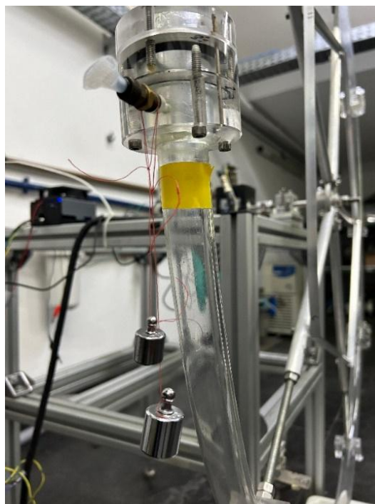
Figura 11: Processo de calibração estática do medidor de torque utilizando massas fixadas à roda.
