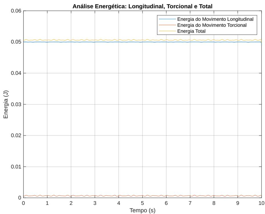
Figura 8: Distribuição da energia total ao longo do tempo. Componentes dos modos de vibração.
