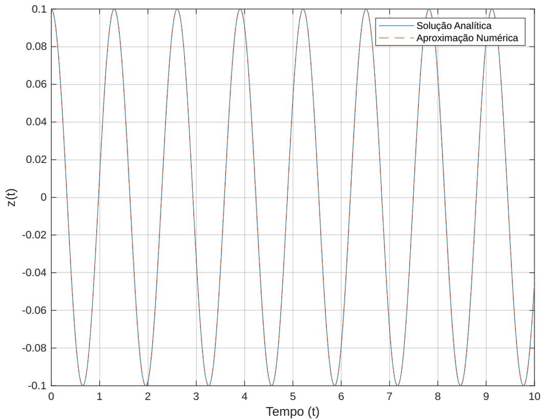
Figura 3: Deslocamento  $z$  em função do tempo. Comparação entre a solução analítica e a aproximação numérica.
