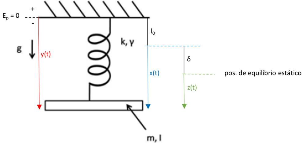
Figura 2: Três possíveis parametrizações para o movimento longitudinal do pêndulo de Wilberforce.
