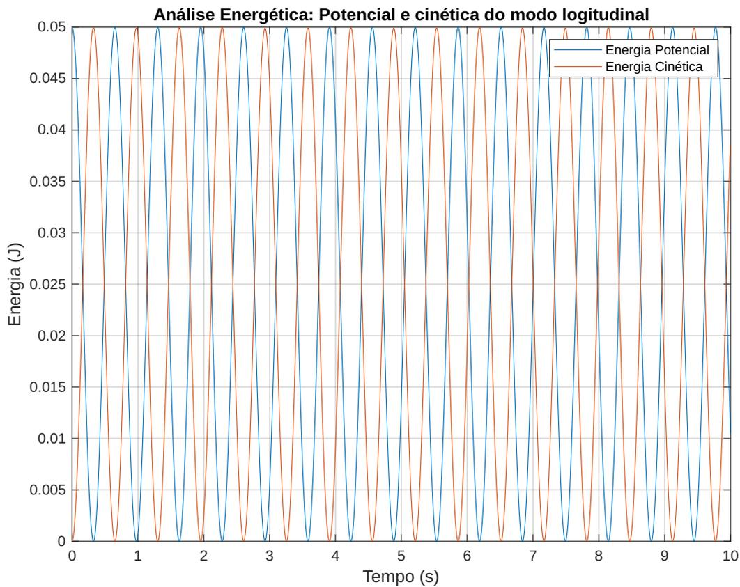
Figura 9: Distribuição da energia total ao longo do tempo - modo longitudinal
