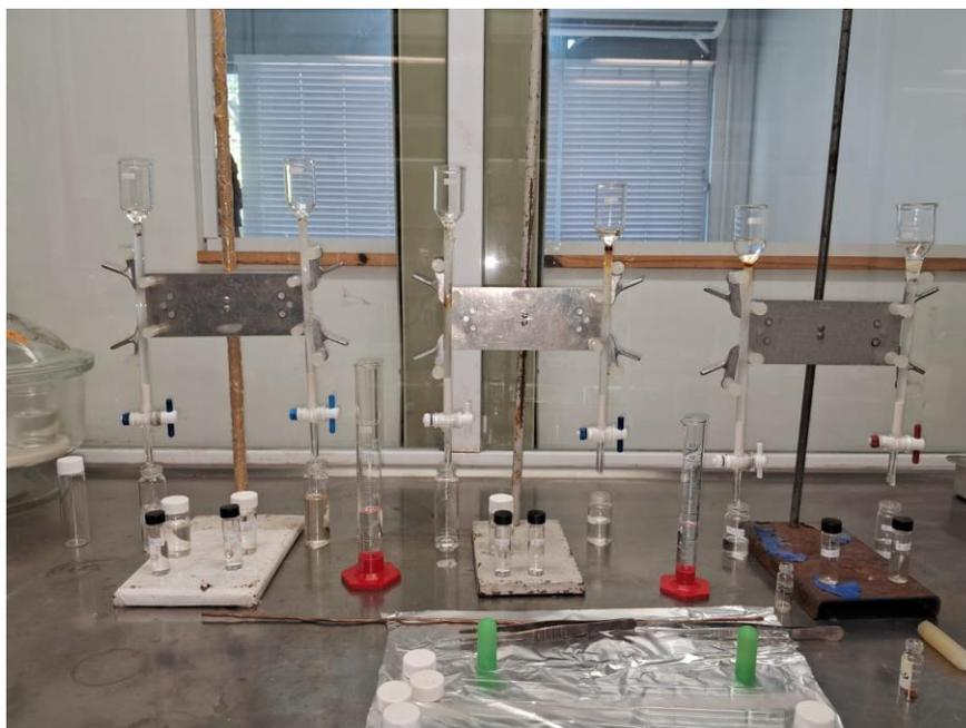
Figura 16 – Separação das frações do extrato por cromatografia líquida de coluna aberta
