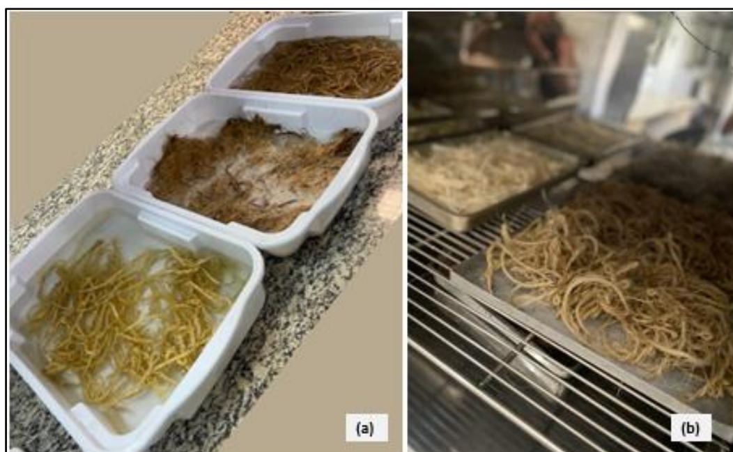
Figura 11 – Tratamento das fibras naturais: (a) Estabilização com água destilada; (b) Remoção da umidade.
