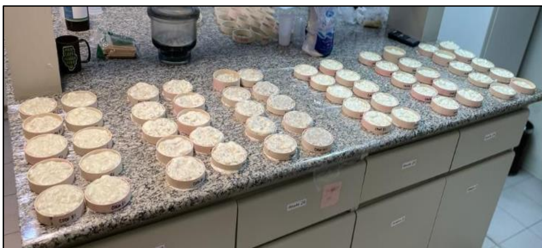
Figura 12 – Compósitos em fase de cura.
