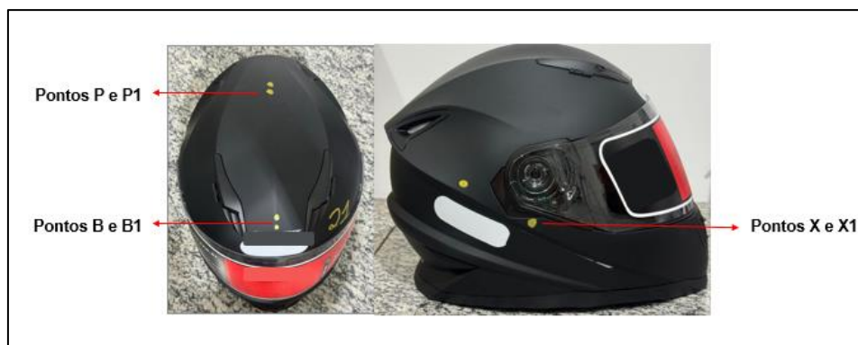
Figura 5 – Capacete com os pontos de impacto marcados.
