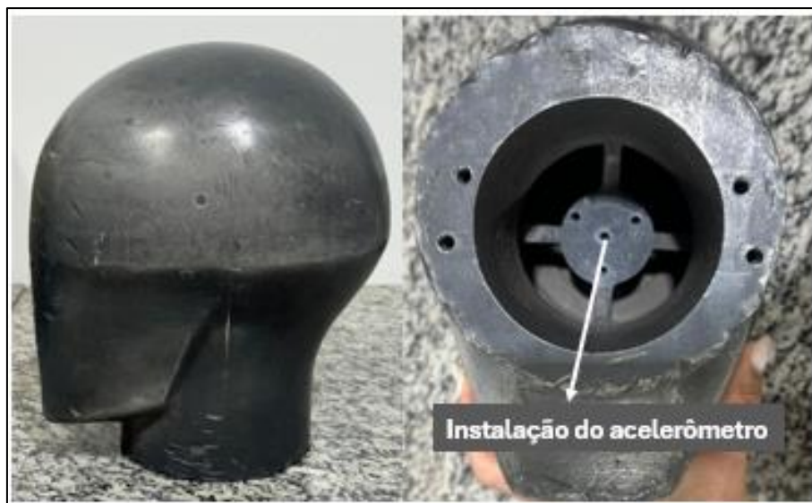
Figura 4 – Localização para a instalação do acelerômetro.
