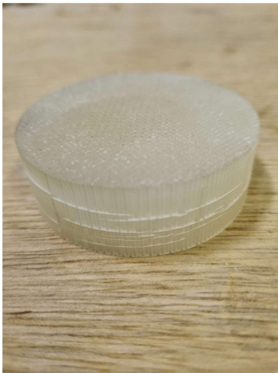
Figura 31 - Fissuras ocorridas, devido à cura insuficiente, durante a secagem na estufa
