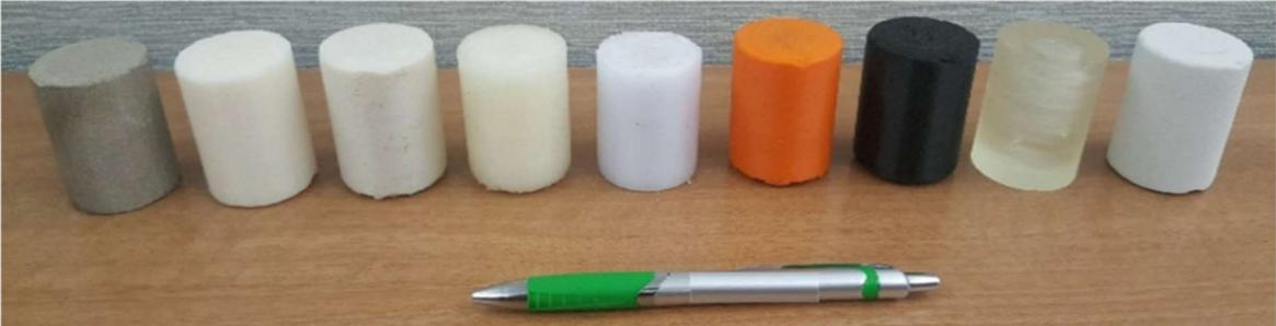
Figura 13 - Amostra original (a esquerda) e réplicas impressas com diferentes técnicas e materiais. Almetwally et al. (2021).
