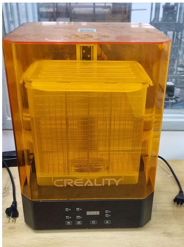
Figura 30 - Equipamento de limpeza e cura da amostra impressa
