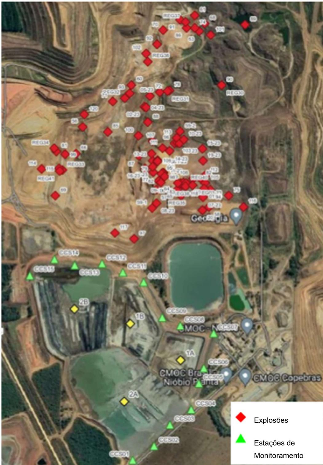
Figura 92: Imagem de satélite com a posição das detonações realizadas e das estações sísmográficas.
