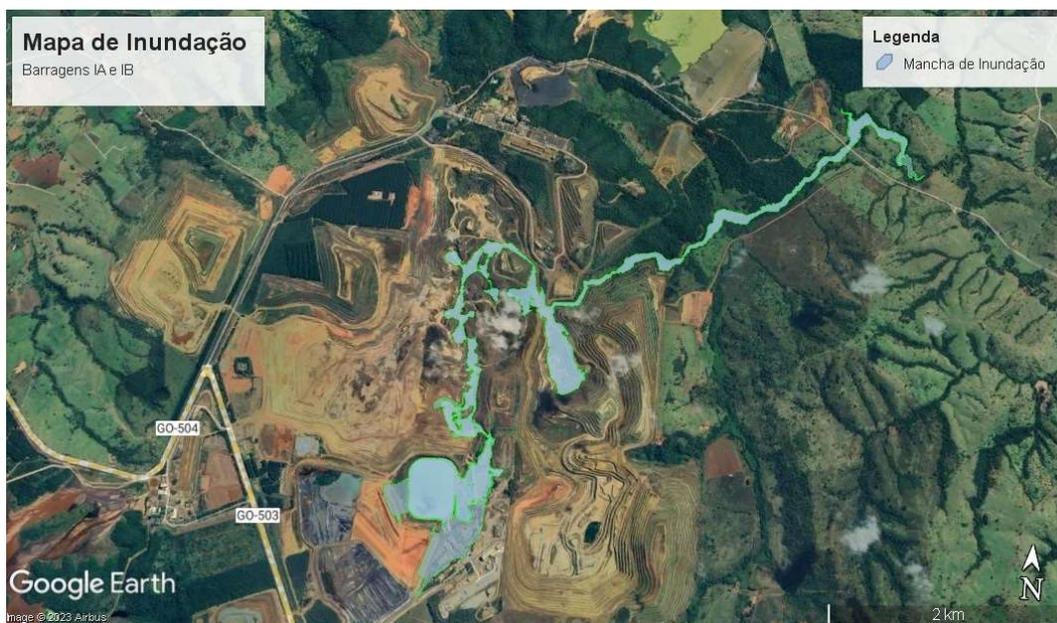
Figura 8: Mancha de inundação para o caso do rompimento das barragens 1A e 1B. Retirado do SIGBM (Sistema de Gestão de Barragem de Mineração, Cadastro Nacional, site ANM).
