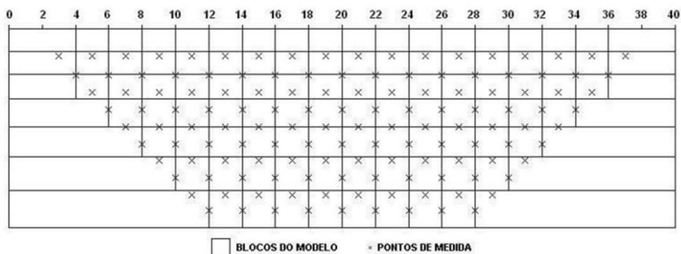
Figura 35: Exemplo de arranjo de blocos utilizado no RES2DINV, arranjo dipolo-dipolo. Retirado de Gandolfo, 2007.
