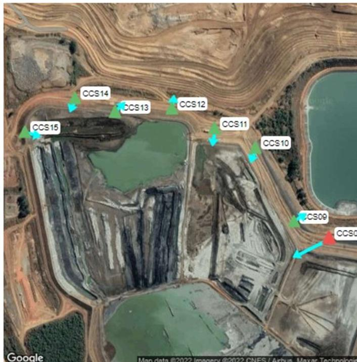
Figura 77: Localização da estação CCS08 indicando a direção da vibração do evento registrado no dia 12 de novembro.
