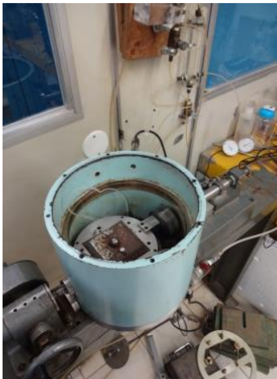
Figura 3.3 – Câmara de Pressão de Ar.
