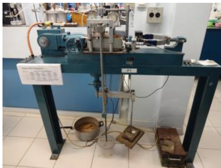
Figura 3.1 – Equipamento de Cisalhamento Direto Convencional da PUC-Rio.
