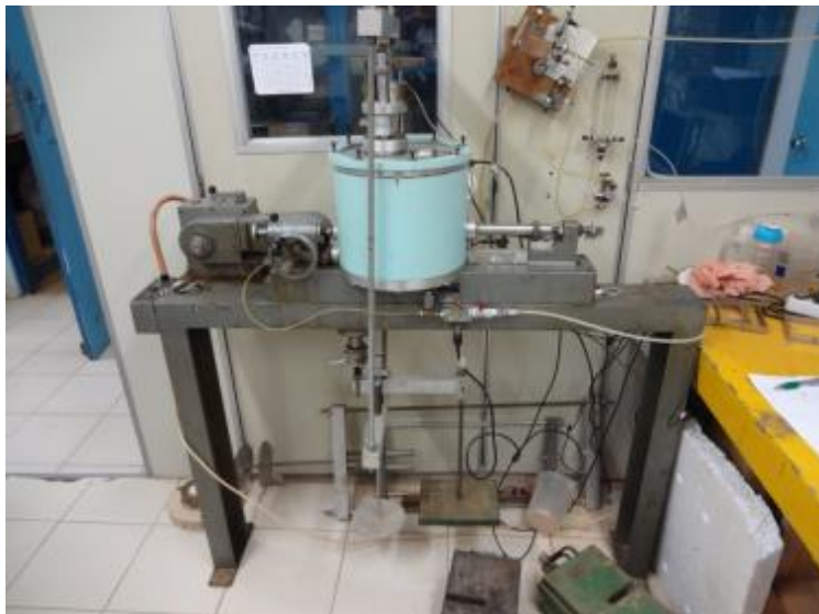
Figura 3.2 – Equipamento de Cisalhamento Direto com sucção controlada da PUC-Rio.
