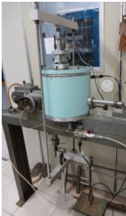
Figura 3.6 – Sistema de aplicação de carga vertical composto por um pendural e braço de alavanca.
