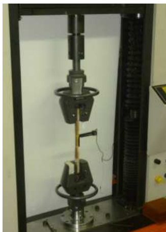
(a) Vista geral do ensaio de tração na máquina universal INSTRON No.6233.
