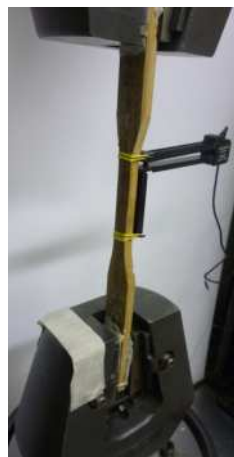
(b) Vista aproximada do corpo de prova para o ensaio de tração.
