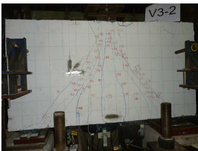
Figura 4.49 – Configuração de fissuras - Viga V3-2.
