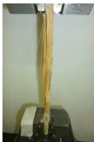
(f) Falha por desprendimento interfacial fibra-matriz
