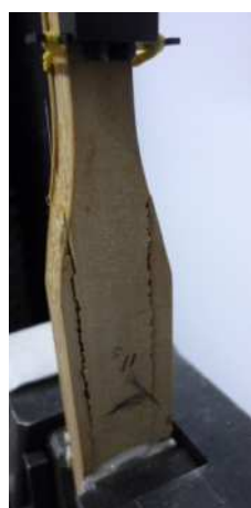
(e) Falha por cisalhante
