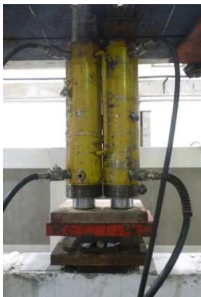
Figura 3.12 – Macacos hidráulicos de 500KN cada um. Conjunto de chapas niveladas de transmissão de carga.
