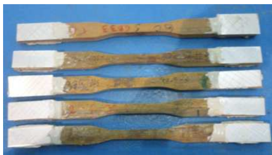
Figura 3.3 – Corpos de prova - material bambu da espécie Dendrocalamus giganteus .
