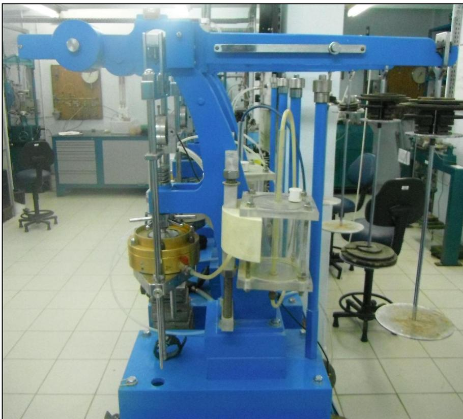
**Figura 4.5 - Ensaio No. V-11, feito com um oedômetro convencional.**
