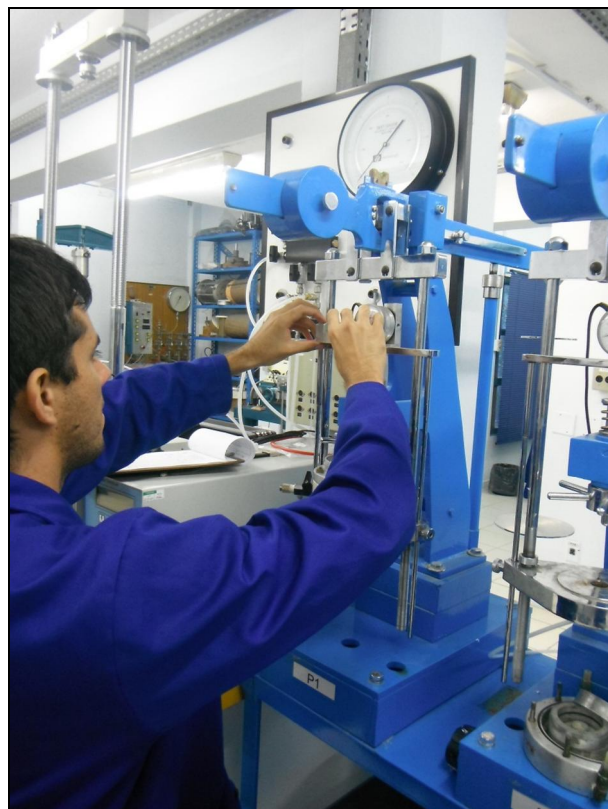
Figura 3.14 - Técnico fazendo o nivelamento da prensa tipo Bishop.
