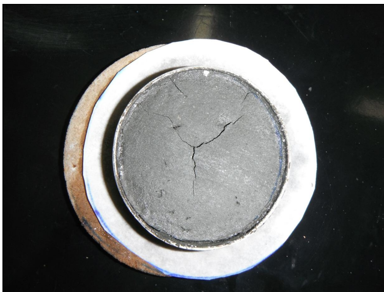
Figura 3.5 - Foto de amostra trincada e afastada do anel de confinamento, depois de ser submetida a uma pressão de vácuo bem maior que a tensão por carga vertical.
