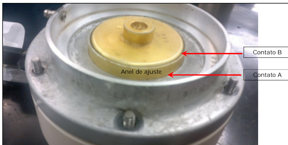
Figura 3.6 - Contato A, entre o anel de ajuste e a parte superior do oedômetro. Contato B, entre o anel de ajuste e o cap.
