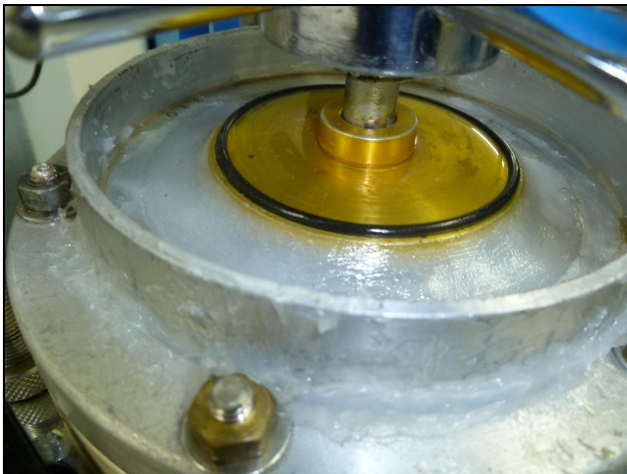
Figura 3.9 - Vedação durante os estágios convencionais de carregamento com pesos. No contato A, graxa de vaselina em grande quantidade, No contato B, água.
