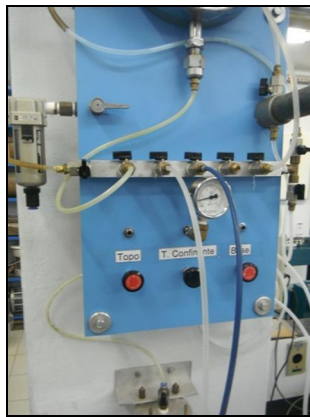
Figura 3.35 - Tabuleiro de válvulas para regulação das pressões na célula triaxial
