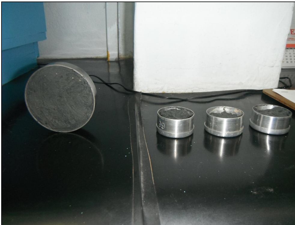
Figura 3.12 - Anel de confinamento com amostra e cápsulas com material para medir o teor de umidade inicial.
