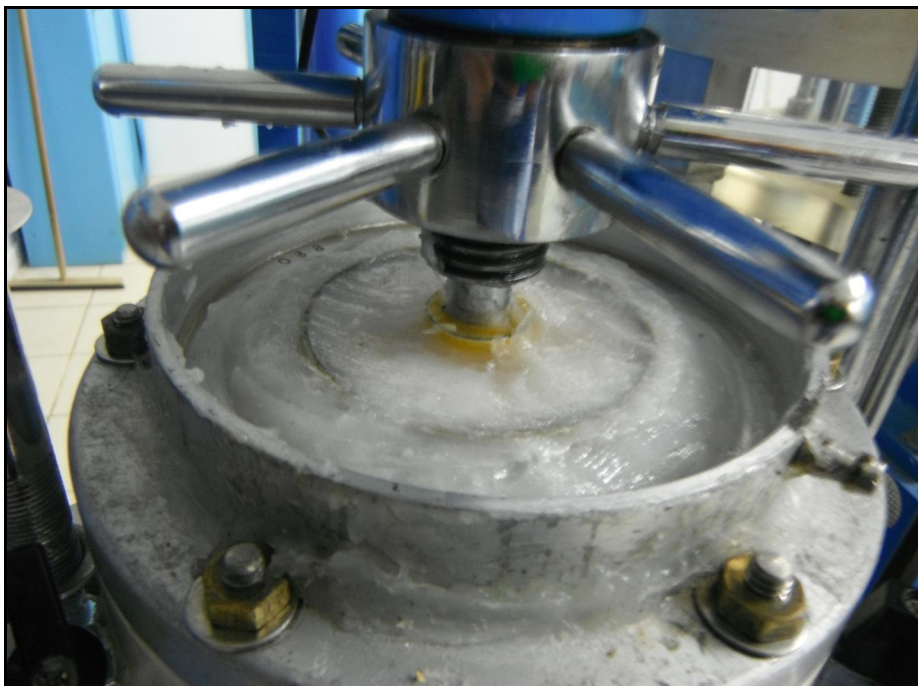
Figura 3.10 - Vedação durante o estágio de aplicação do vácuo. Nos contatos A e B se botou graxa de vaselina em grande quantidade.
