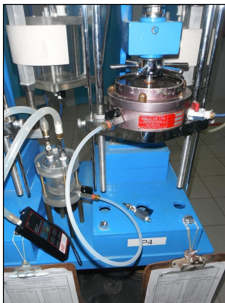
Figura 3.2 - Montagem do ensaio de adensamento em um oedômetro convencional
