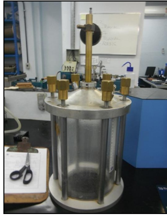
Figura 3.34 - Parte superior da célula triaxial
