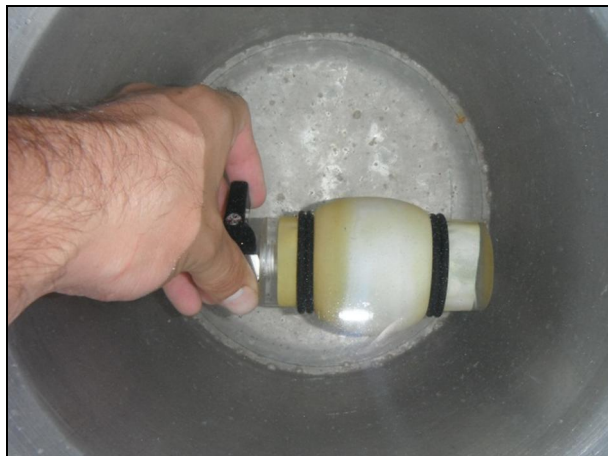
Figura 3.29 - Teste para detectar presença de furos na membrana
