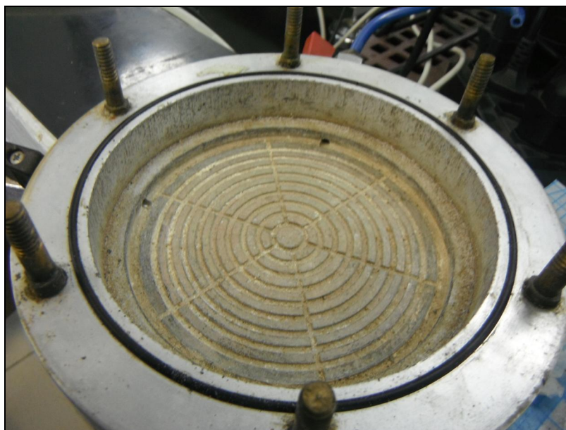
Figura 3.3 - Interior da base de oedômetro convencional
