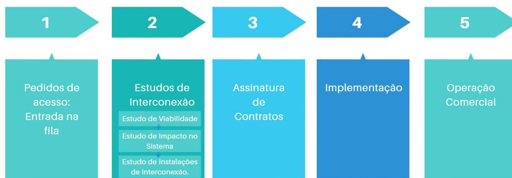
Figura 2.1: Fluxograma do processo de acesso dos Estados Unidos. Adaptado de [7].
