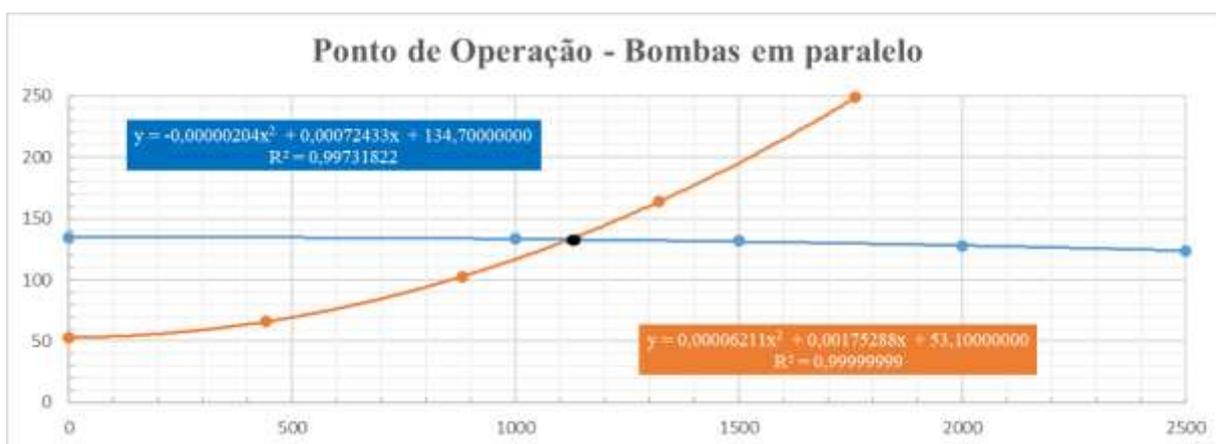
Figura 9.10 – Ponto de operação das bombas em paralelo com o tanque reserva vazio. Fonte: Elaborado pela autora, 2024.
