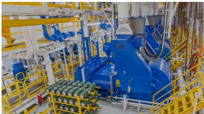
Figura 5.13 – Bombas alternativas de pistão em sonda de perfuração. Disponível em: <https://www.nov.com/products/mud-pumps-fluid-mixing-and-processing-systems>. Acesso em: 21 de jul. de 2023.
