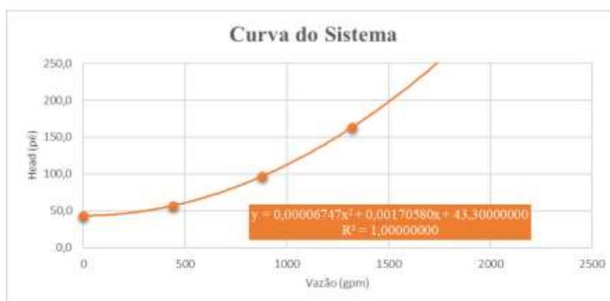
Figura 9.5 – Curva característica do sistema com o tanque reserva cheio. Fonte: Elaborado pela autora, 2024.
