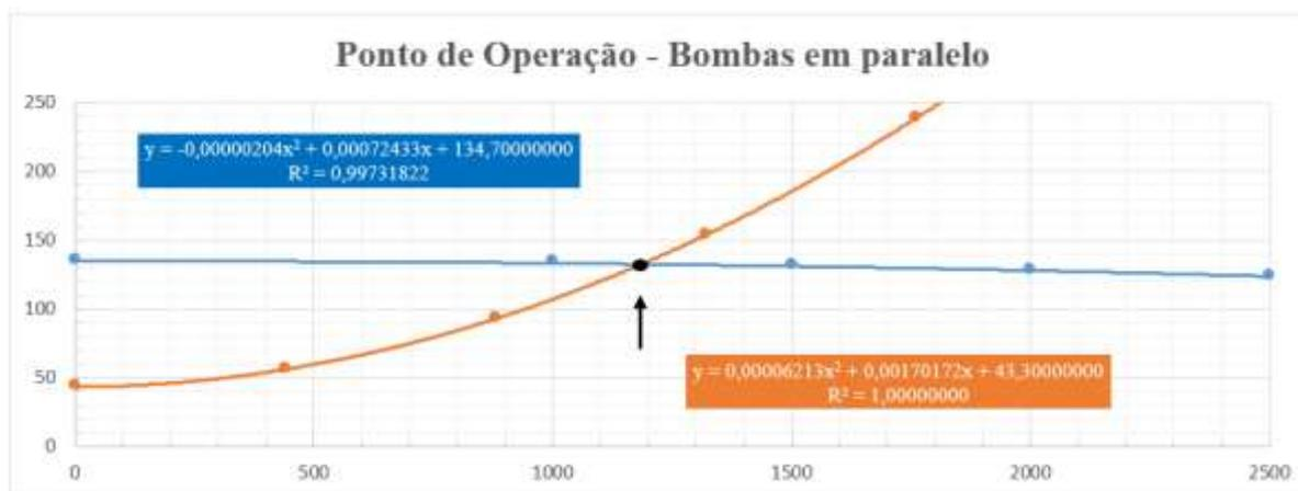
Figura 9.8 – Ponto de operação das bombas em paralelo com o tanque reserva cheio. Fonte: Elaborado pela autora, 2024.
