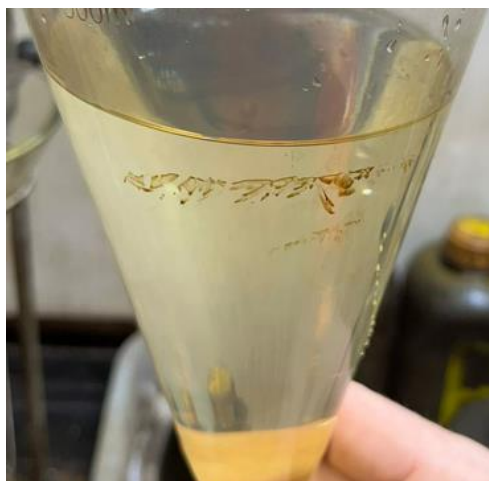
Figura 6 – Análise de TOG após o tratamento com peróxido de hidrogênio 1x sem catalisador. Resultado equivalente com e sem catalisador. pH = 1; temperatura ambiente; TOG espectrofotométrico = 5 ppm.
