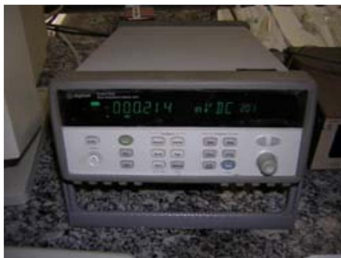
**Figura 2** – Coletor de dados *Agilent 34970A*
