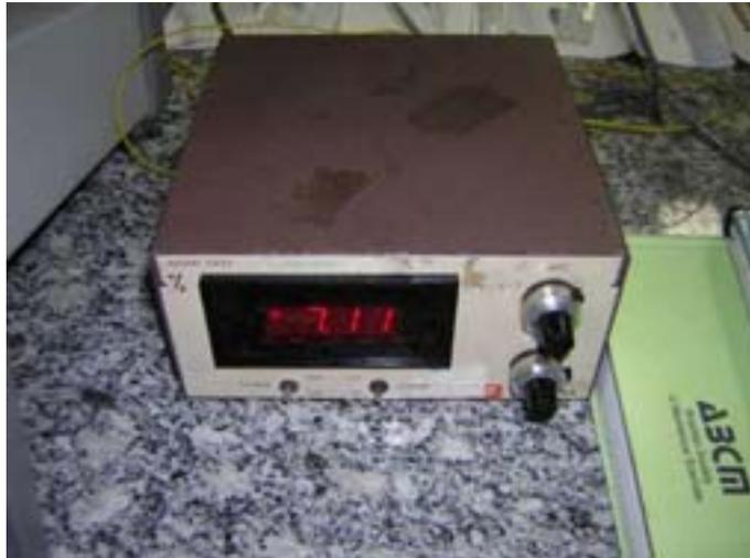
**Figura 3** – Medidor da diferença de pressão *Validyne*.
