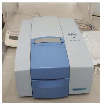
Figure 5.2: FTIR spectrometer used to study the vibrational characteristics of the sample in the Laboratório de Revestimentos Protetores e Materiais Nanoestruturados at PUC-Rio.
